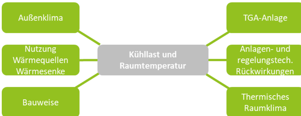
Abbildung 2-3: Einflussparameter auf Kühllast und Raumtemperatur nach VDI 2078
