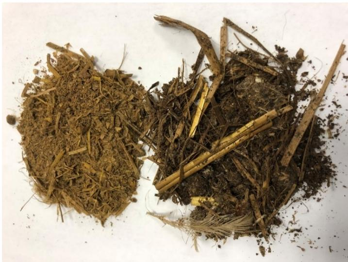
Abbildung 3-6: Vergleich der behandelten (links) und unbehandelten (rechts) Probe
