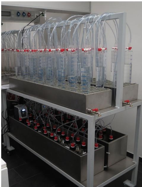
Abbildung 3-14: Aufbau der Eudiometerversuche
