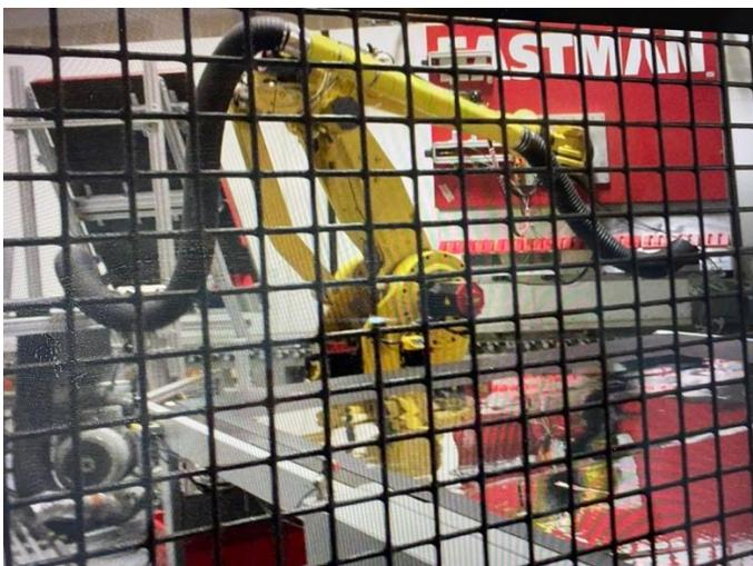
Abbildung 11: Fanuc-Folienapplikationsroboter
