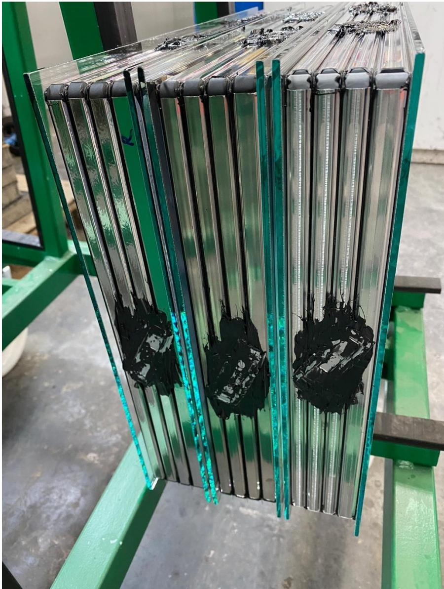
Abbildung 22: Testreihe mit rudimentärer Stabilisierung
