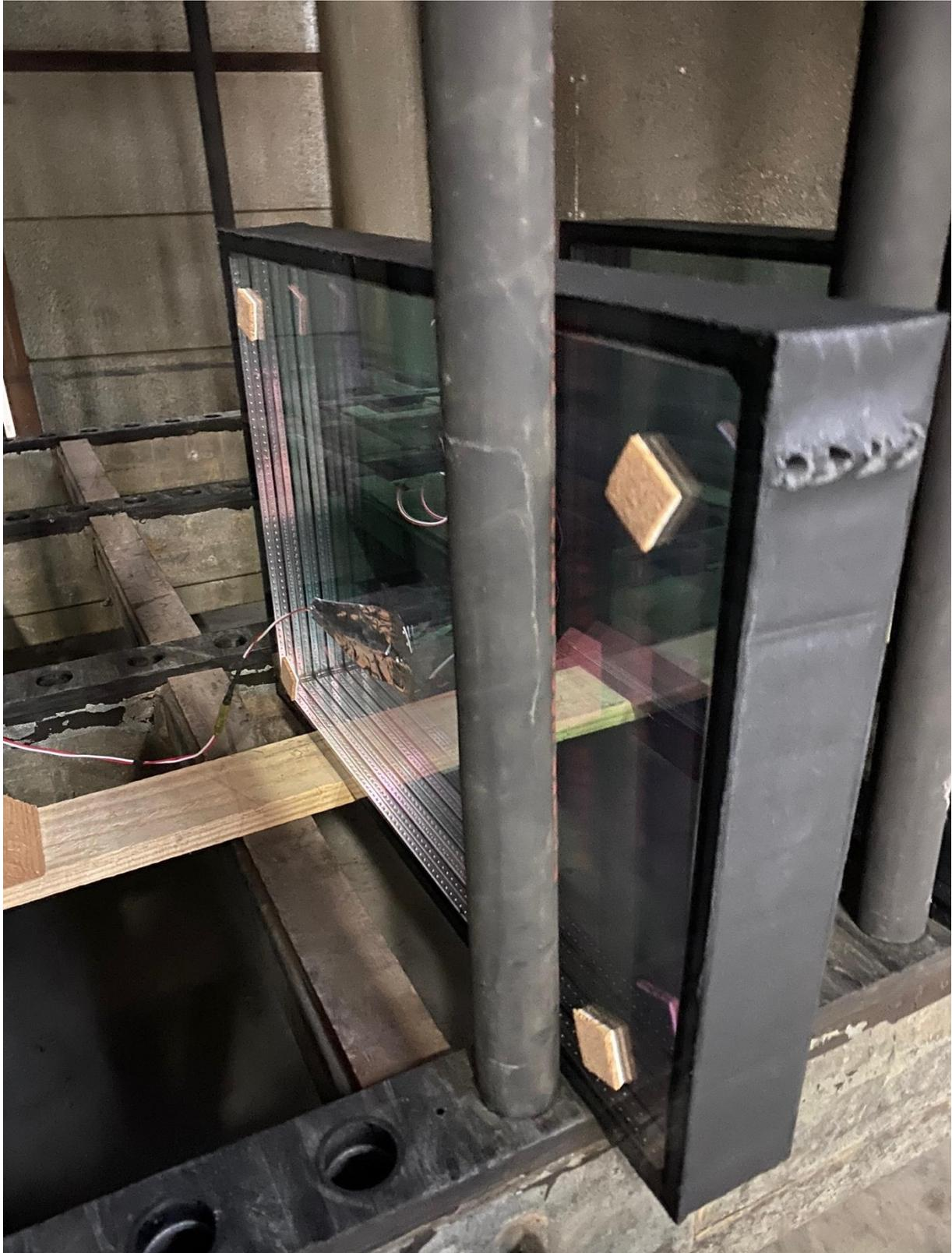
Abbildung 24: Testreihe mit Temperatursensoren im Ofen
