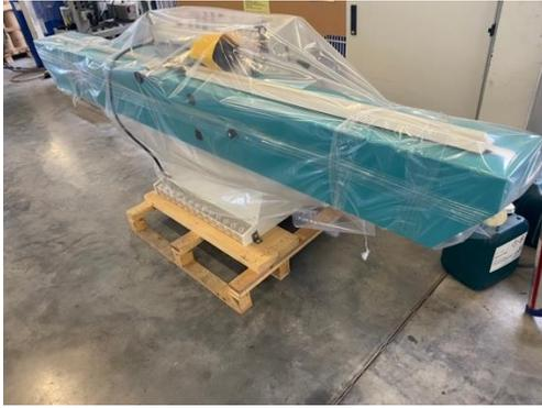
Abbildung 17: neue Butylextruderanlage für HM-Produktion
