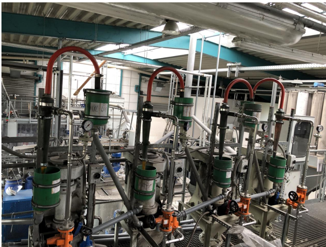
Abbildung: Versuchsanlage zur mehrstufigen Zyklonierung nach Abbildung 4.23
