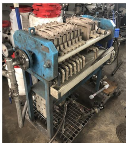
Abbildung: links: schematischer Aufbau der Filterkammerpresse [Walt17] // rechts: Versuchsanlage Filterkammerpresse mit zentralem Suspensionszulauf und offenen Filtratauslauf
