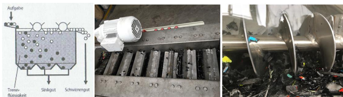
Abbildung: links: schematischen Aufbau [JVRW18] // mitte: Draufsicht des Schwimm-Sink Scheiders // rechts: Austragsschnecke für das Schwimmgut (Kunststoff)
