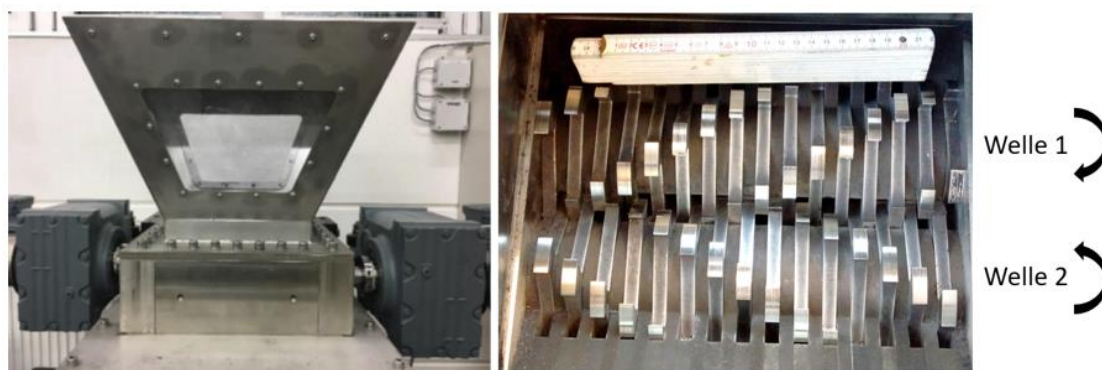
Links: Seitenansicht der Rotorschere, Fa. Ermafa // rechts: Draufsicht in Zerkleinerungsraum
