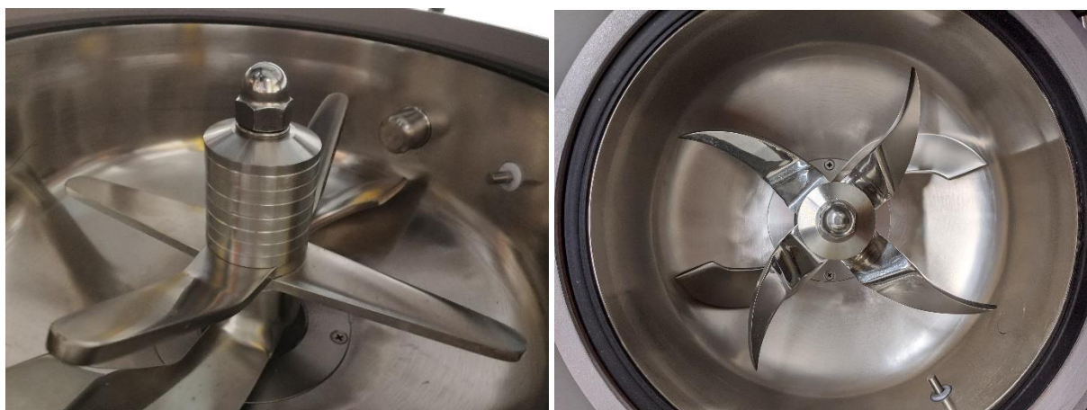
Abbildung A.1: Schnellmisch-Werkzeug, Seitenansicht (re) und Intensiv-Werkzeug, Draufsicht (li)
