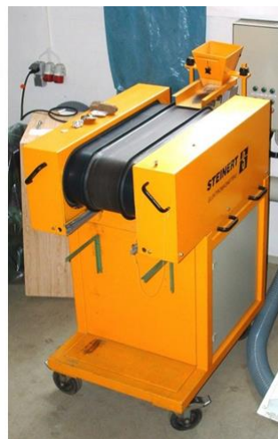
Abbildung: links: schematischer Aufbau eines Wirbelstromscheider (L= NE- Metalle) [Lieb14] // rechts: Versuchsanlage Wirbelstromscheider
