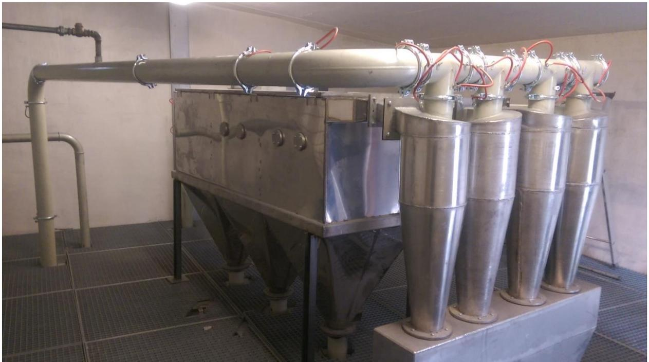
Abb. 4: Rückwärtige Ansicht des 3-Kammerquerstromsichters mit 4-fach Multizyklon [Quelle: Eigene]
