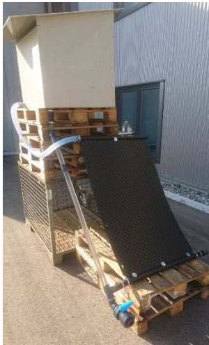
1. Versuchsanlage für Wasserverdampfungstest
