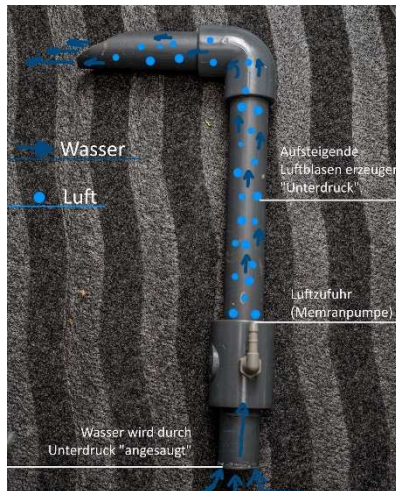
Erläuterung Luftzufuhr durch Membranpumpe
