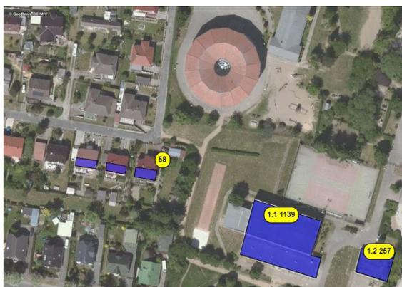
Abbildung 3c): Für PV-Anlagen nutzbare Dachflächen von Einfamilienhäusern im Vergleich mit Dachflächen von öffentlichen Gebäuden
