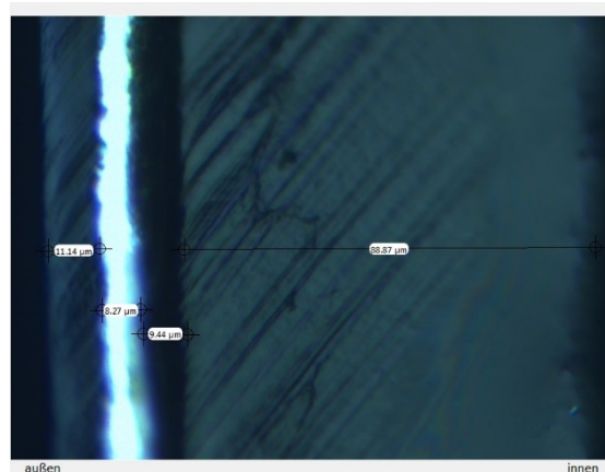
Abbildung 32: Lichtmikroskopische Abbildung eines Querschnitts einer Lebensmittelverpackung aus Folienverbundmaterial
