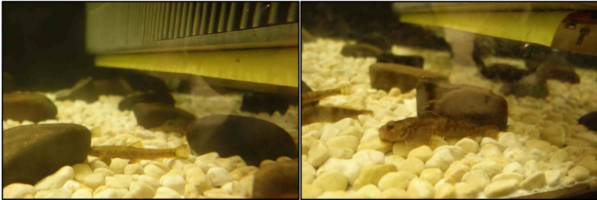
Abb. 5.6: Scheuchvariante Vibration. Oben links: Aluwinkel unter Schieberechen. Oben rechts: Vibration des Winkels. Unten links: gescheuchte Schmerle unter dem Einfluss der Vibration. Unten rechts: gescheuchte Groppe unter Einfluss der Vibration
