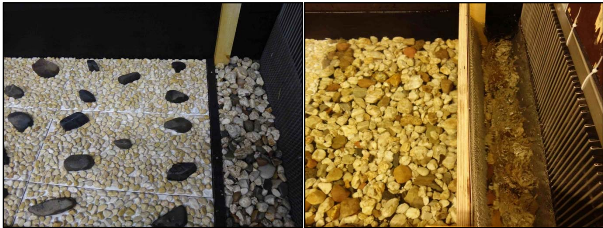
Abb. 5.1: Substrate. Links: künstliche Sohle mit Störsteinen. Rechts: Flusskies zur Simulation einer natürlichen Sohle.
