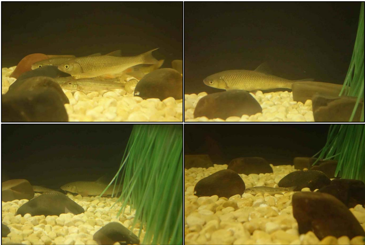
Abb. 5.10: Oben links: Durchwandern der künstlichen Sohle in Fangkammer ohne Scheuchwirkung des Unterwasserrechens. Oben rechts: Döbel hält Abstand von Borsten. Unten links: Barbe wird von Borsten berührt und gescheucht. Unten rechts: Gründling wird von Borsten ohne Berührung gescheucht.
