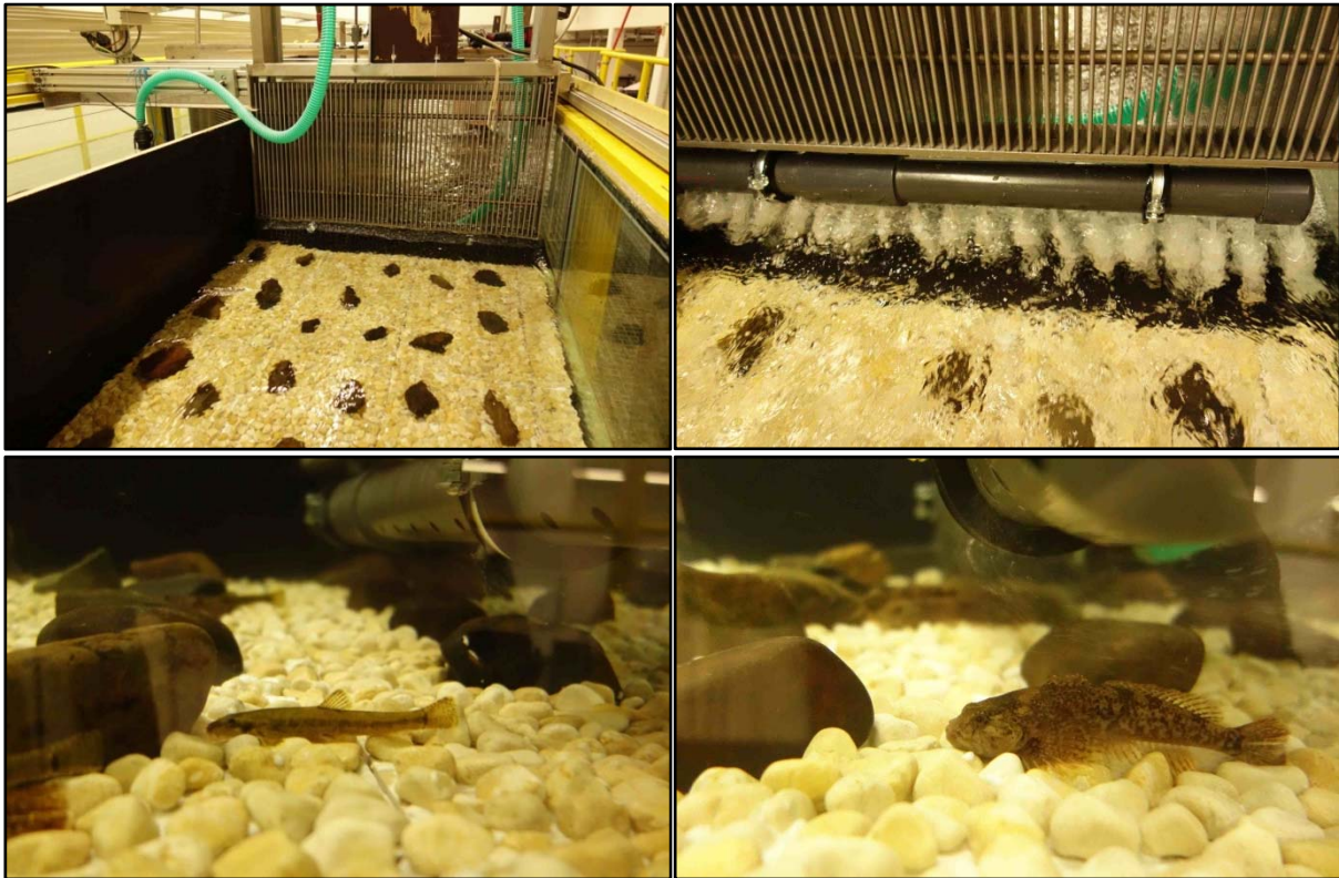
Abb. 5.5: Scheuchvariante Wasserstrahl. Oben links: Zulaufschlauch für Wasserstrahl am Rechen. Oben rechts: Austretende Wasserstrahlen. Unten links: gescheuchte Schmerle unter Einfluss des Wasserstrahls. Unten rechts: gescheuchte Groppe unter dem Einfluss des Wasserstrahls.
