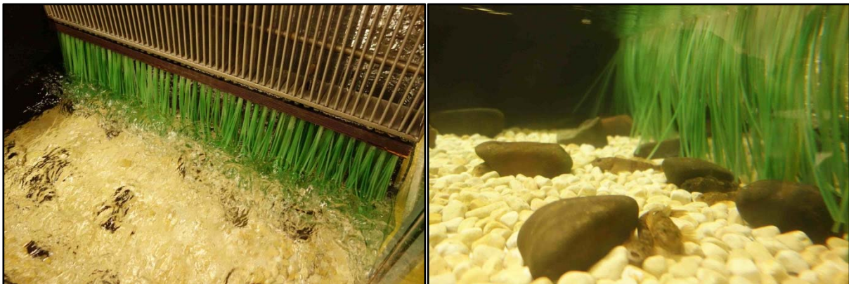
Abb. 5.7: Scheuchvariante Borsten. Links: Kunststoffborsten unter Schieberechen. Rechts: gescheuchte Groppen unter dem Einfluss der Borsten.
