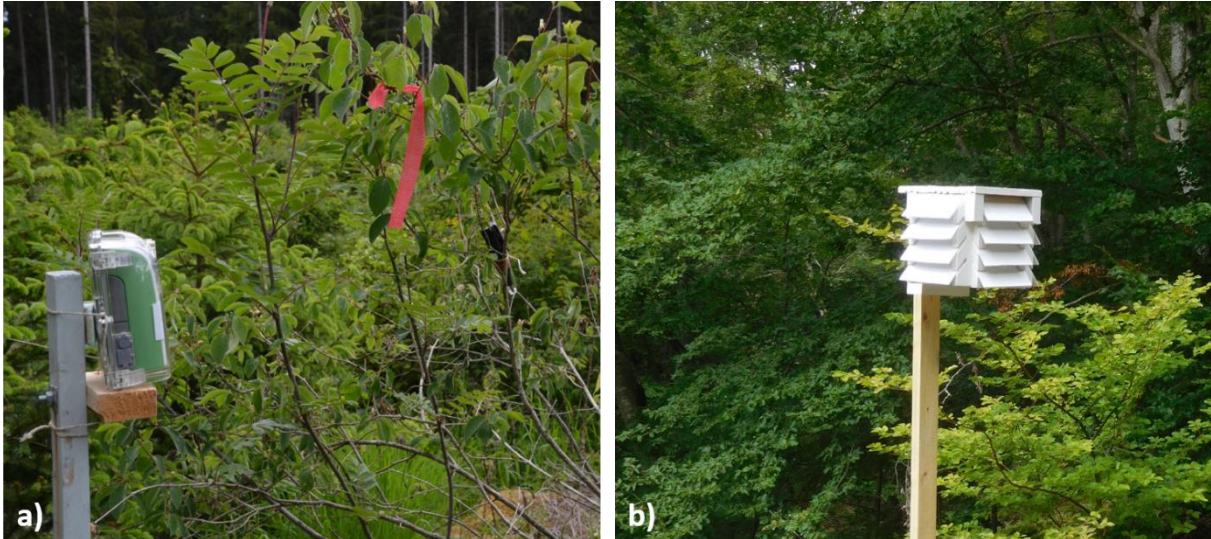
Abbildung 3: Erhebung von Raupenaktivität und Klimadaten. a) Eine Zeitrafferkamera filmt die Raupe des Blauschwarzen Eisvogels und hilft bei der Erforschung von Fraßverhalten und Mortalitätsursachen. Rechts im Bild ist ein Klimadatenlogger zu sehen, der Temperatur, Taupunkt und Luftfeuchte direkt am Fraßplatz der Raupe aufzeichnet. b) Durch Klimahütten wurde in jedem Untersuchungsgebiet ein Klimadatenlogger vor direkter Sonneneinstrahlung geschützt.
