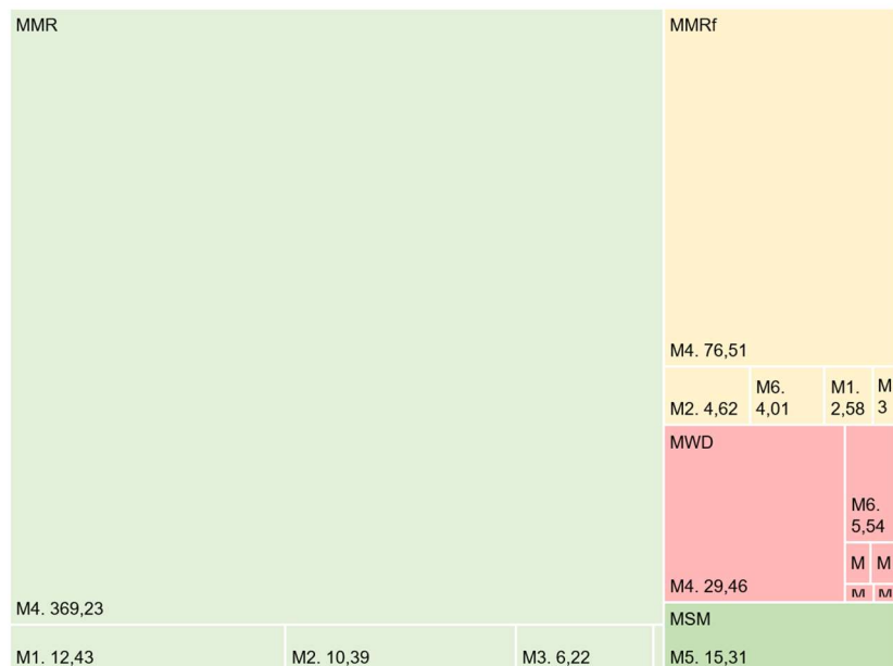
Abbildung 4: Bauteilebene | Massenverhältnis des Bauteils und der Baustoffe hinsichtlich der Recyclingfähigkeit
