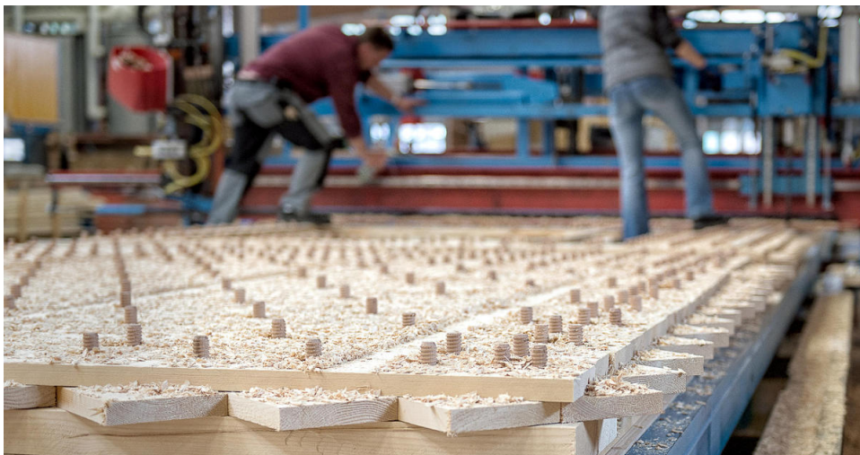
Abbildung 20: Produktion der verschraubten NUR-HOLZ Elemente (Quelle: NUR-HOLZ)
