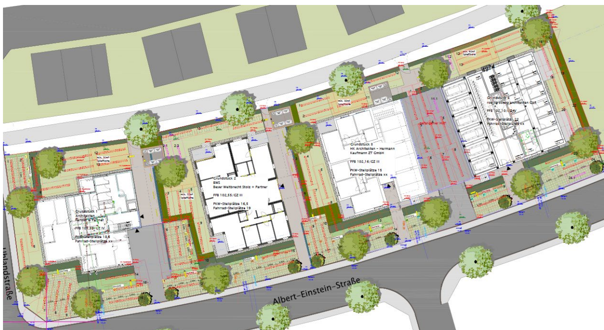
Abbildung 84: Untersuchte Variante mit Erdwärmeabsorbern in den Außenanlagen
