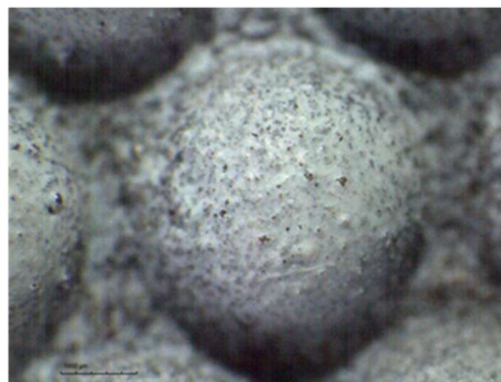
RP Teil mit \text{TiO}_2 beschichtet
