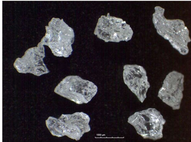
Abbildung 10 Strahlgut zur Bearbeitung der Glasoberfläche
