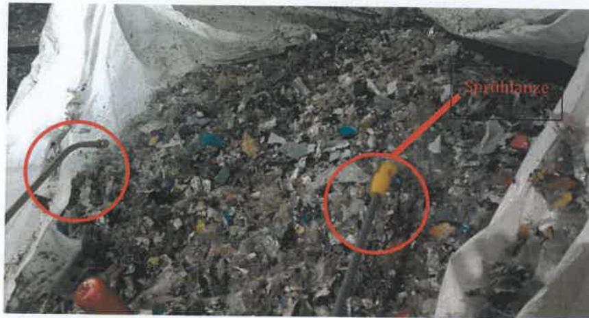
Abbildung 25 Folienabfall (EBS-fraktion) bei der Besprühung mit Bakterienlösung PIP Aquatec basic
