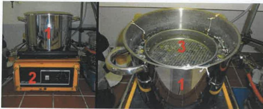
Abbildung 14 Versuchsaufbau der Adaptionphase mit PIP Aquatec Basic in einem Topf (1) auf einem Laborschüttler (2) mit Beschwerung (3)
