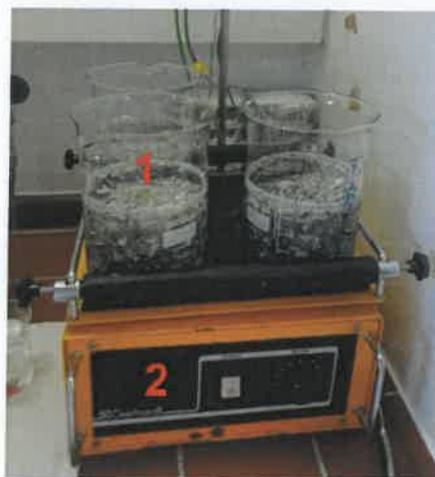
Abbildung 18 Versuchsaufbau der Kunststoffwäsche mit Einsatz probiotischer Bakterien
