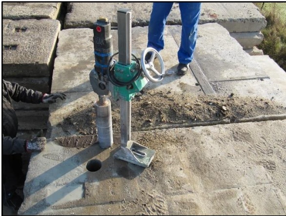
Foto 5.11: Bohrkernentnahme an Straßenbauplatte Nr. 87
