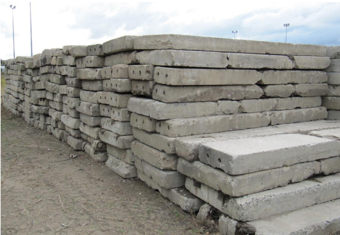
Abb.1: Zwischenlager der Straßen-Betonplatten nördlich des Sportplatzes [Fak.2, AG Bauliches Recycling]
