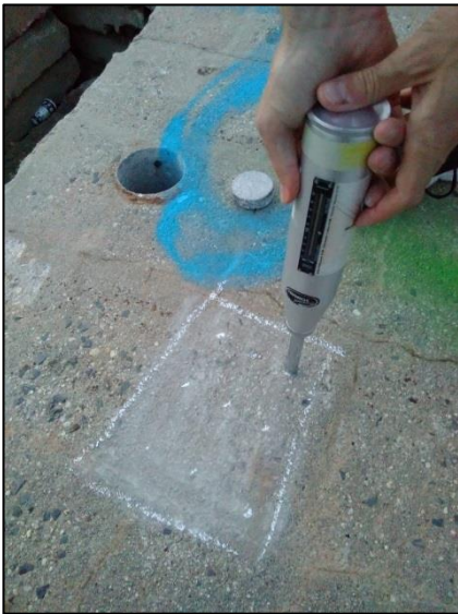
Foto 5.10: Prüfung der Druckfestigkeit mittels Prüfhammer; rechts: Bewehrungsseisen (Flachstahl 1,0 x 0,5 mm)
