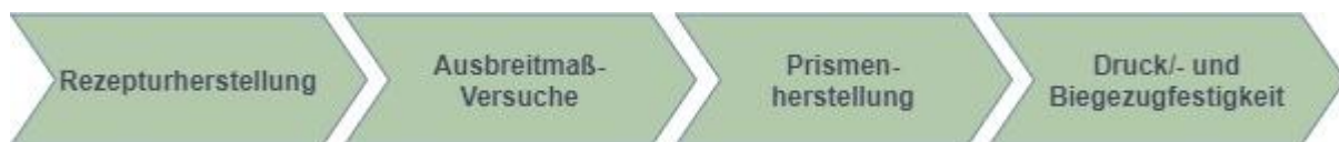
Abbildung 4.5: Prinzipieller Ablauf der RC-Mörteluntersuchungen
