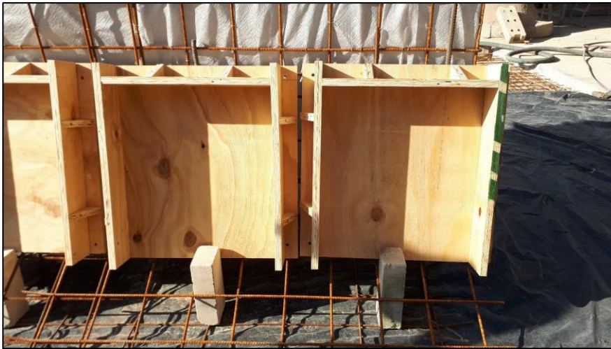
Foto 4.9: Aufgestellte Spritzkästen aus Sperrholzplatten für die Spritzversuche [Foto: Fischer]
