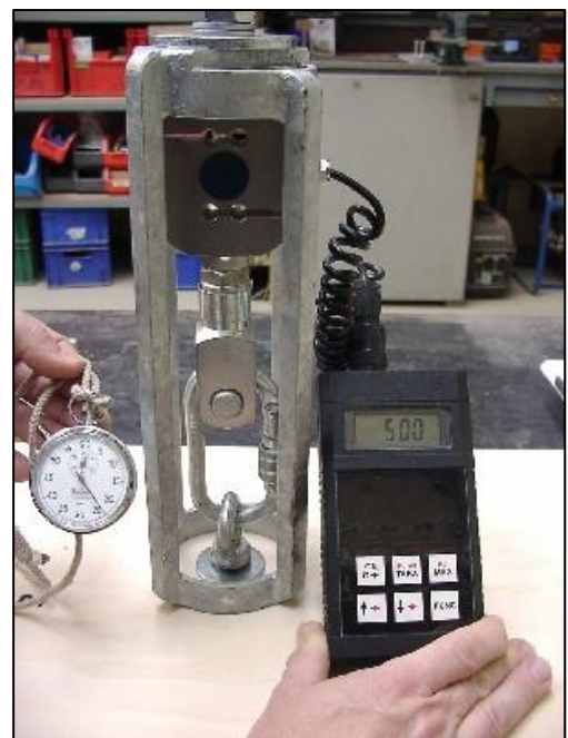
Foto 5.2: Prüfung der Ausziehungskraft eines Sicherungshakens , Foto: http://www.trainingsanlagen.info/kletteranlagen.htm
