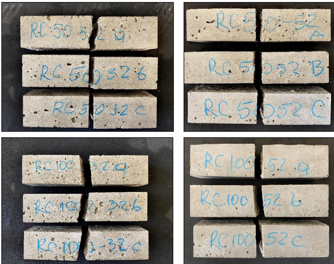
Foto 4.8: Bruchbilder Mörtelprismen aus Versuchsreihe 2 nach Biegezugfestigkeitsprüfung [Fotos: M. Golubeva]
