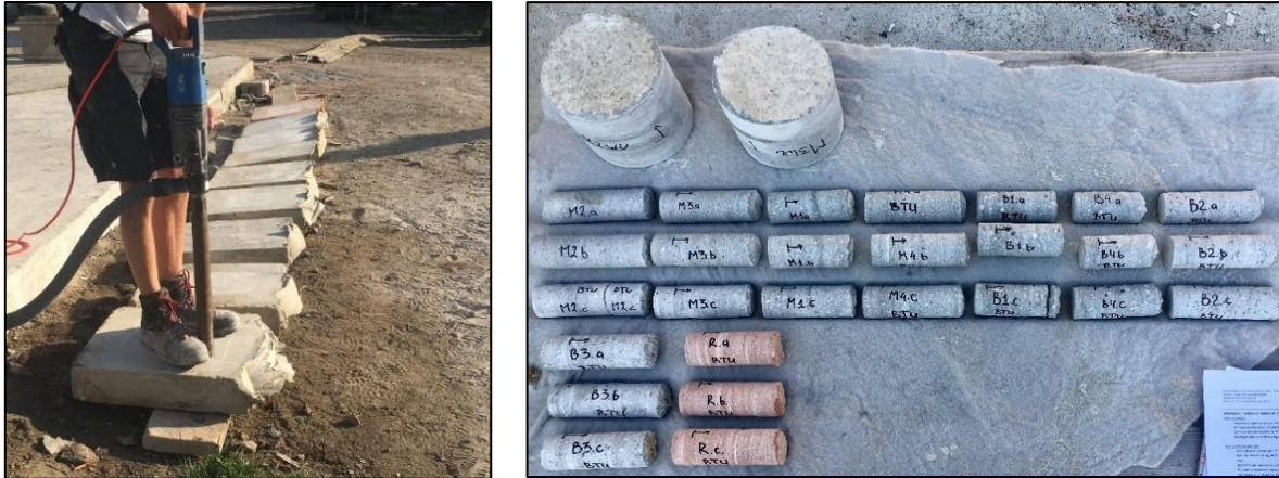
Foto 4.14: Bohrkernentnahme und beschriftete Bohrkernkerne
