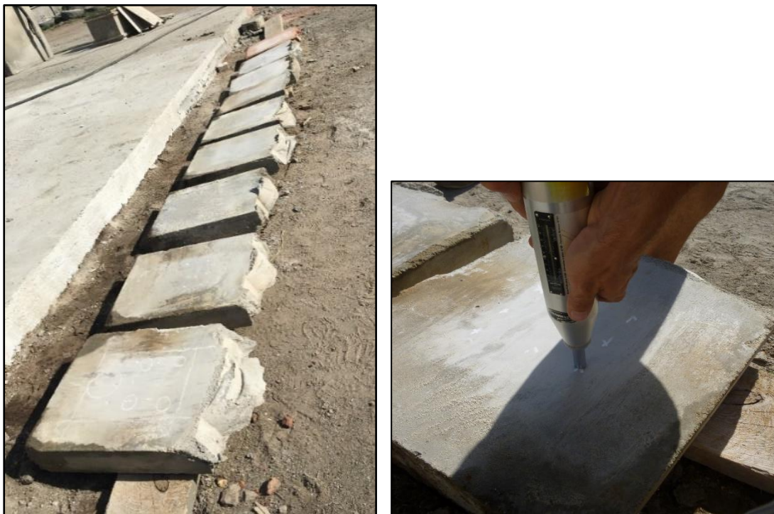
Foto 4.13: Spritzkörper mit gekennzeichnetem Messstellenbereich (links) und Prüfung mit Rückprallhammer (rechts)
