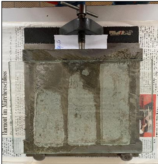
Foto 4.5: Prismen nach der Herstellung, abgedeckt mit leicht geölter Glasplatte (links) und Lagerung in NaOH-Lösung nach 48 h (rechts) [Foto: Golubeva]
