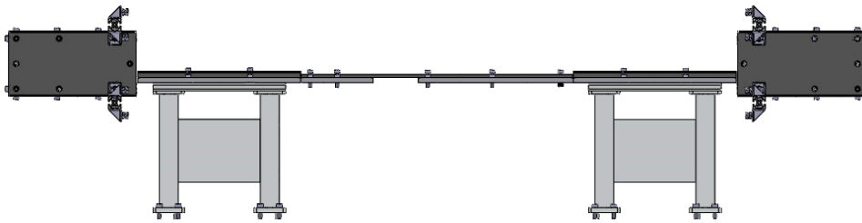
Abbildung 11: Konzept für die Blechführung
