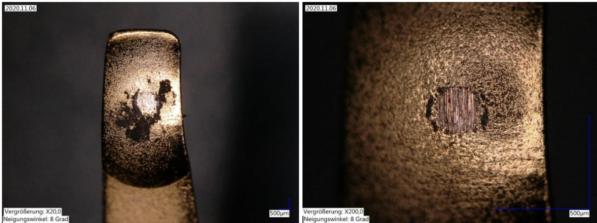
Abbildung 42: Links: Reibstelle und Abrieb an Au auf CuZn. Rechts: Vergrößerung, Abrieb entfernt
