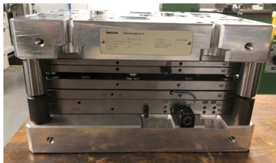
Abbildung 17: Schnappscheiben-Werkzeug (CAD links, Real rechts)
