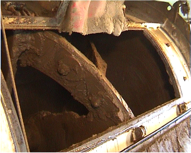
Abb. 97: Zwangsmischer – horizontaler Einbau
