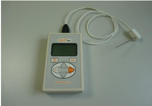
Abb. 22: Instationäres Wärmeleitfähigkeitsmessgerät KD2 Pro
