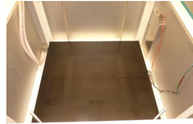
Abb. 31: Heizplatte auf dem 1. Probekörper
