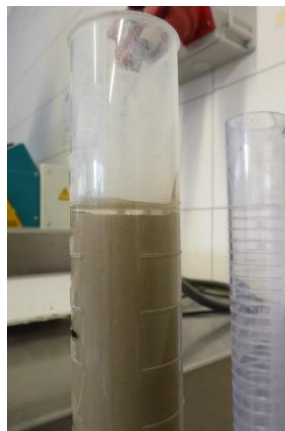
Abb. 21: Abgesetzte Wassermenge nach 3 h
