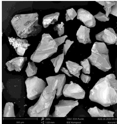
Abb. 6: REM Aufnahme des pulverförmigen Mischkorunds
