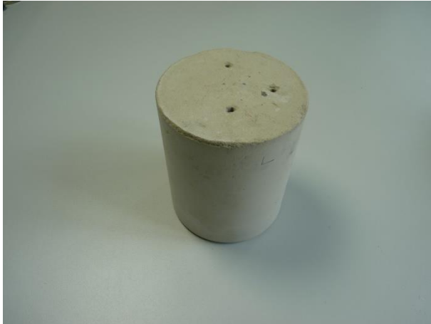
Abb. 24: Probekörper mit Bohrlöchern für Sonde
