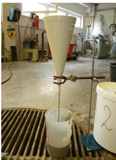
Abb. 17: Bestimmung der Marshzeit mittels Auslauftrichter
