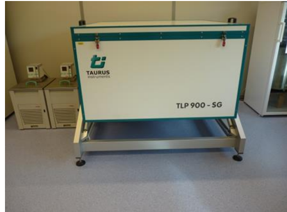
Abb. 23: Stationäres Wärmeleitfähigkeitsmessgerät Taurus TLP900-SG
