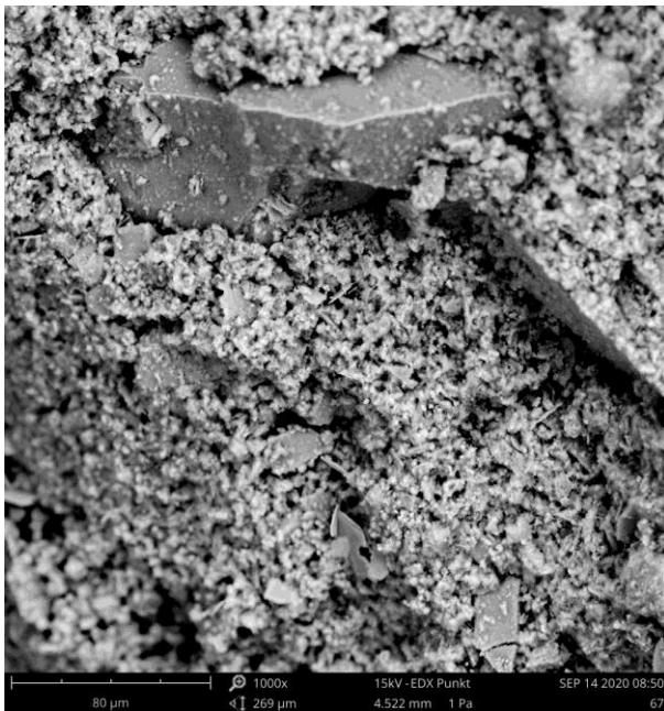
Abb. 81: REM-Aufnahme der hydratisierten Mörtelmischung 67
