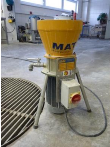
Abb. 16: Intensivmischer SC-5-K der Fa. MAT
