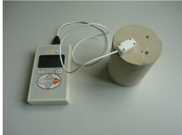
Abb. 25: Probekörper während der Wärmeleitfähigkeitsmessung
