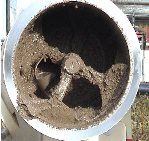
Abb. 101: Mischer mit Mischgut
