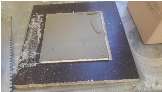
Bild 17: Gipskartonplatte mit Fliesenkleber
