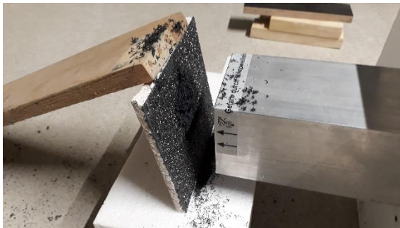
Bild 29: Beschichtete Gipskartonplatte vor rechteckigem Strahler
