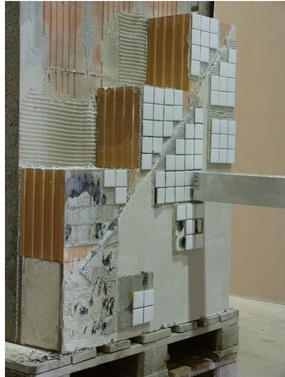
Bild 52: Trennerfolge nach Mikrowellenbehandlung am Wand-Demonstrator
