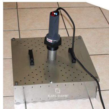
Bild 47: Fliesenabtrennung mittels Stemmhämmer [2] bzw. thermischer Behandlung [3]
