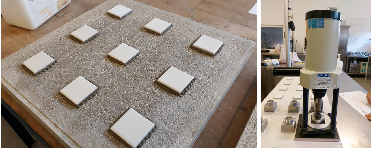
Bild 36: Präparierte Haftzugproben auf Betonoberfläche (links) und Haftzugprüfgerät (rechts)
