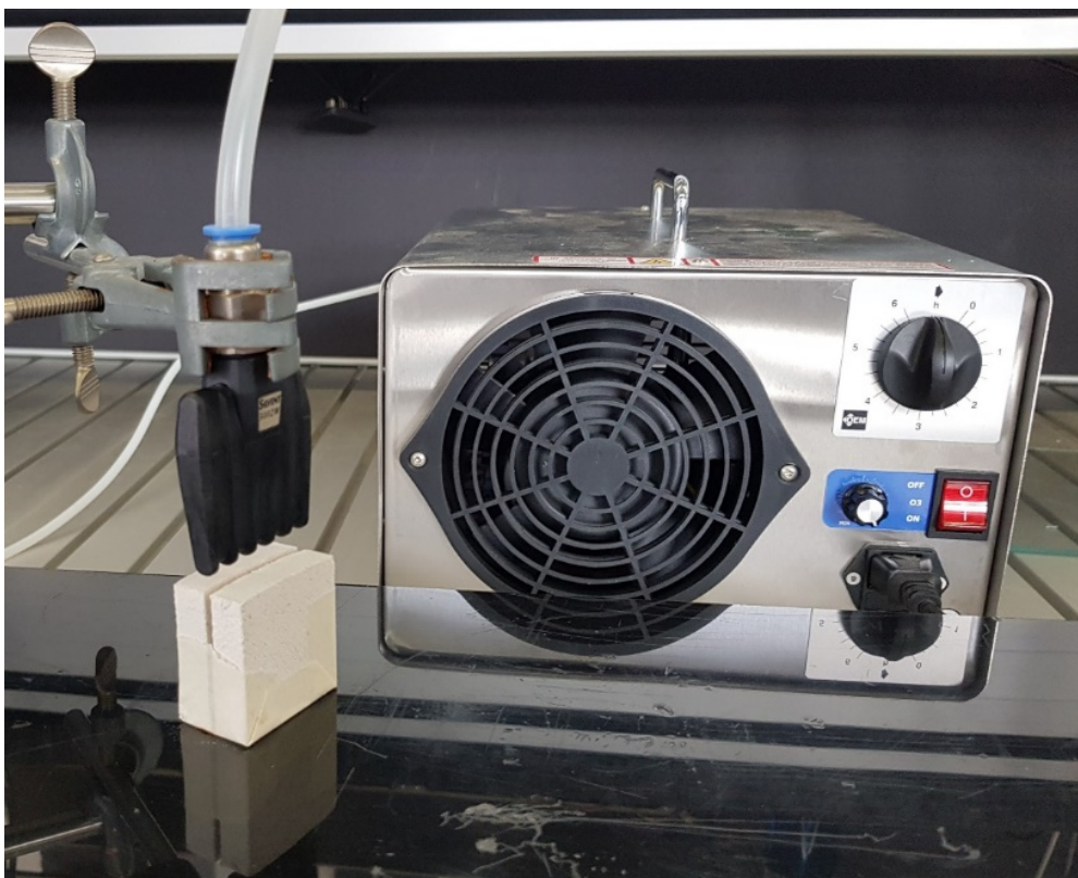
Abb. 109: Aufbau einer Ozonbehandlung mittels Lavaldüse, Düsenabstand zum Substrat von ca. 4 mm
