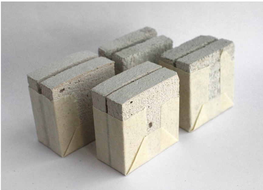
Abb.87: Prüfkörper mit zwei definierten Hohlräumen aus Gipsputzmörtel 57598 (links) und HKCP Kalkputz 57383 (rechts)
