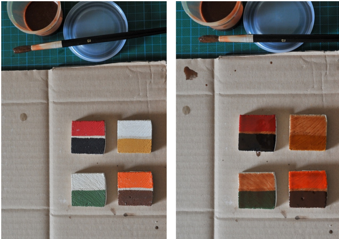
Abb. 92: Links Prüfkörper mit Farbauftrag der ausgewählten Farbabfolgen, rechts nach Auftrag mit pigmentiertem Leinölfirnis
