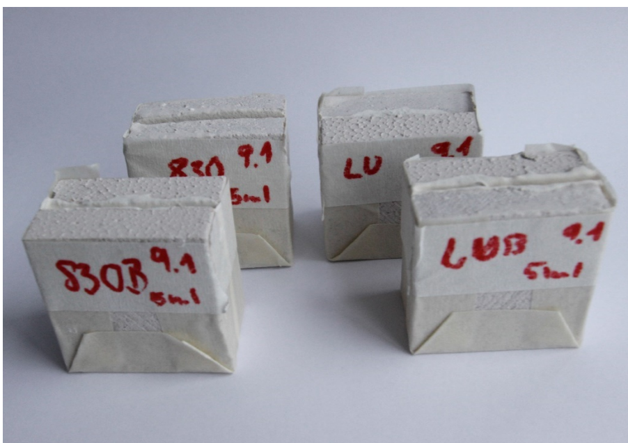
Abb. 86: Prüfkörper mit Hinterfüllung der Mörtel der Prüfreihe KS 9.1
