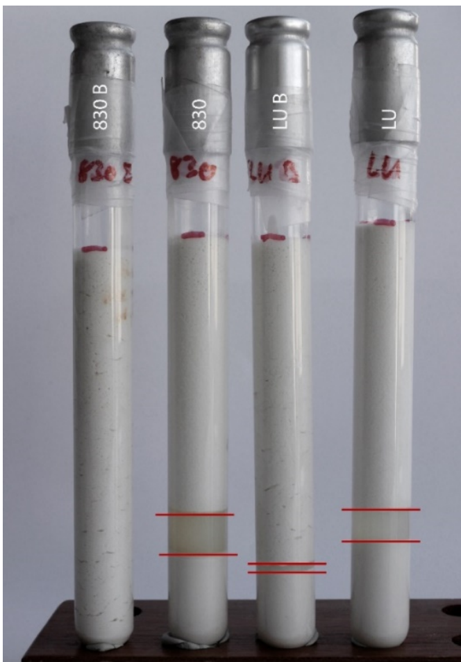
Abb. 81: Testreihe 9.1 zur Sedimentationsgeschwindigkeit mit eingezeichneten Sedimentationsgrenzen (rot) nach sieben Tagen
