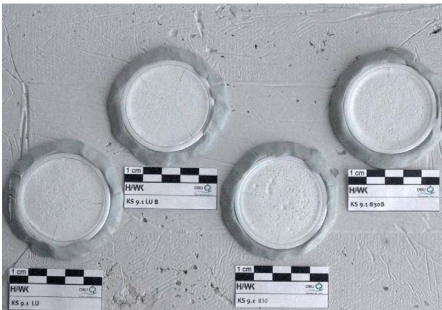
Abb. 84: Trocknung der Hinterfüllmörtel im Rohring nach 2 Tagen auf Gips-Untergrund
