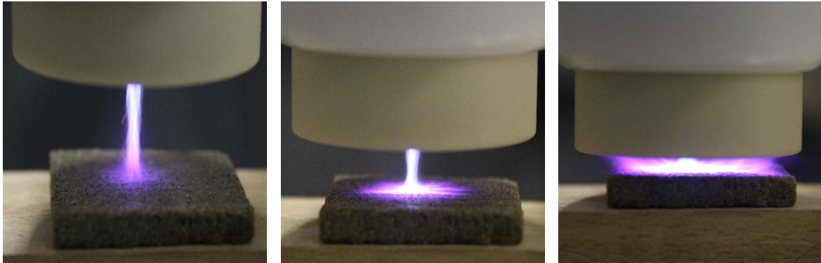
Abb. 100: Entladung der Disc-Jet-Miniaturisierung auf Gipsprüfkörpern
