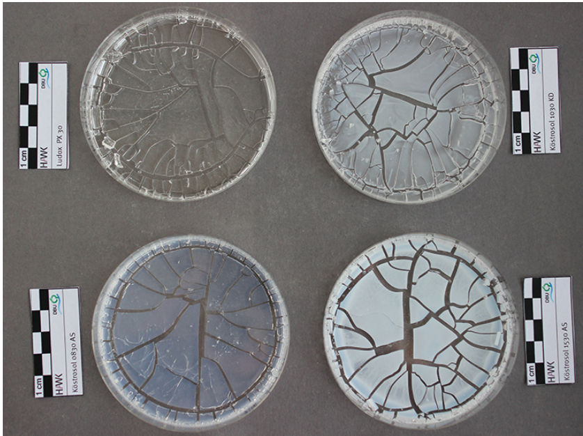
Abb. 163: Petrischalentest der Kieselzol nach 9 Tagen
