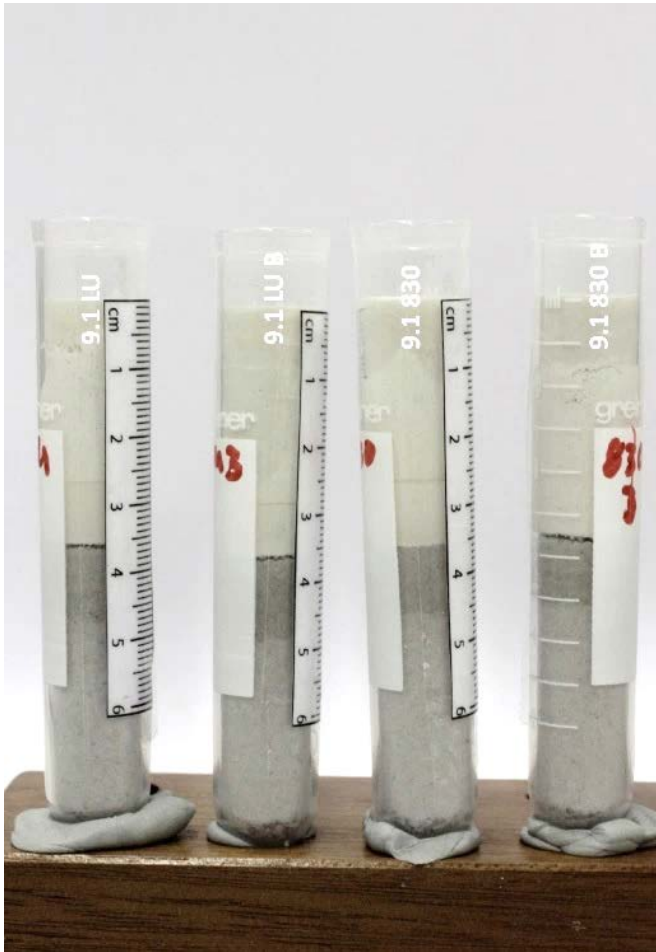
Abb. 82: Penetrationstest Reihe 9.1 aller Mörtel nach zwei Tagen
