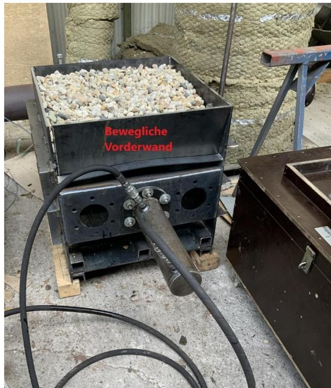
Abbildung 6: Aufbau Kiespresse
