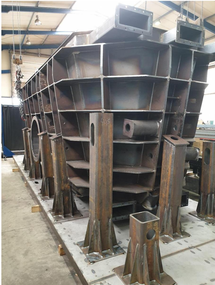
Abbildung 12: Wärmespeicher auf Plattform
