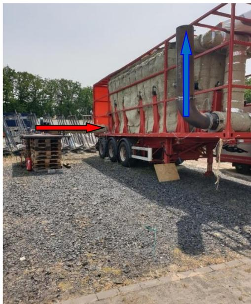
Abbildung 20: Versuchsaufbau realer Wärmespeicher, hier mit abgedeckter Plane und Eintritt des warmen Gases (roter Pfeil) und Austritt des bei der Beladung des Speichers abgekühlten Gases (blauer Pfeil), bei Entladung Eintritt Kaltluft (roter Pfeil) und Austritt Warmluft (blauer Pfeil)
