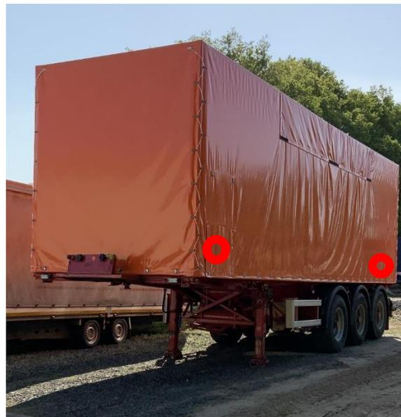
Abbildung 17: Fertiggestellter Wärmespeicher die Lage, der von der Plane verdeckten Ein- und Austrittsstutzen sind rot markiert, die in die Plane integrierten Öffnungsmöglichkeiten sind erkennbar
