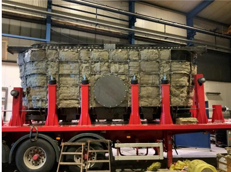
Abbildung 16: Einghängter Wärmespeicher
