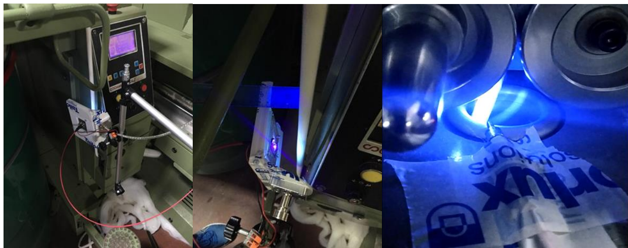
Abbildung 6 : InlineVerification Point 2 – die Quantifizierung am Kardenband.
