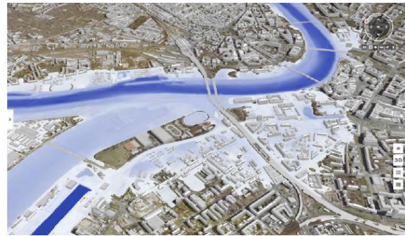
Abbildung 17: Verschiedene Darstellungsmöglichkeiten von Ergebnissen aus der 2D-Simulation: Fließgeschwindigkeit (links), Wassertiefe (rechts) bei einem außergewöhnliches HW.
