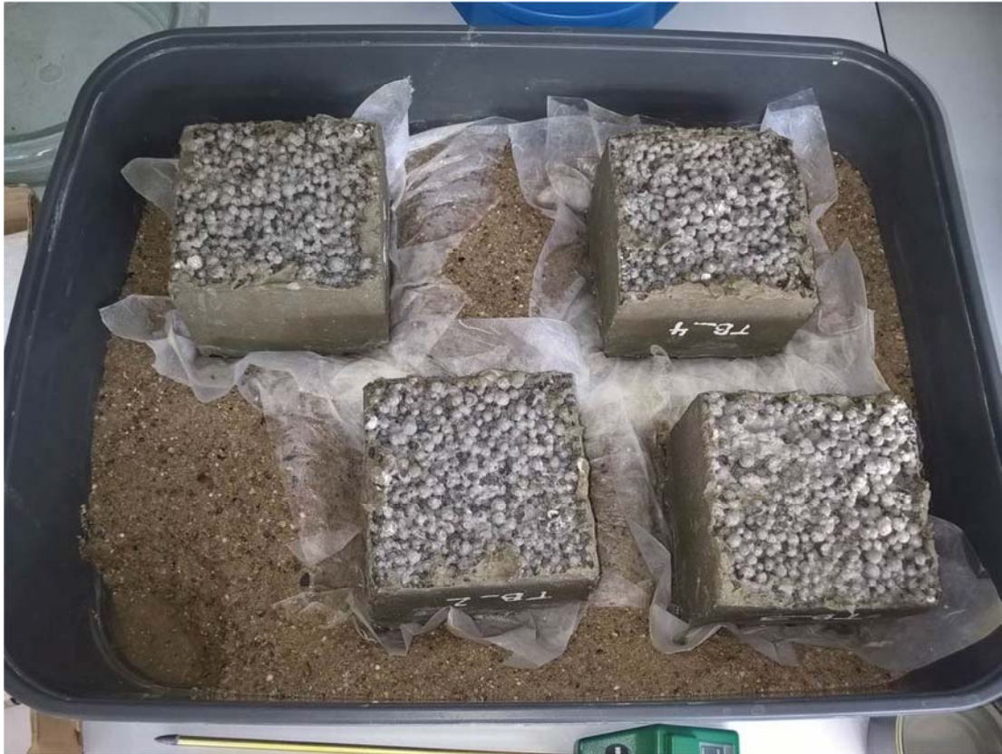
Abb. 55 Probekörper in einem durchfeuchteten Sandbett gelagert
