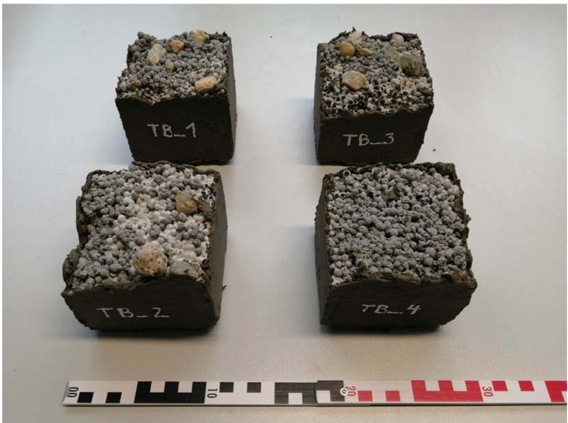
Abb. 54 mit einer Dichtschlamme versehene Probekorper (Unterseite liegt oben)
