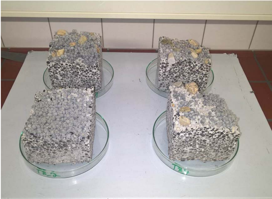
Abb. 53 zugeschnittene Probekörper ohne Randabsperungen (Unterseite liegt oben)
