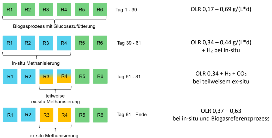
Abbildung 6: Übersicht zur Prozessfahrweise am Mehrfach-Testreaktor für die Referenzreaktoren R5 und R6 im klassischen Biogasbetrieb (grün), den Übergang vom klassischen Biogasbetrieb auf die in-situ Methanisierung (grün auf blau) in R1 und R2 und den Übergang vom klassischen Biogasbetrieb grün über die in-situ Methanisierung (blau) auf die ex-situ Methanisierung (gelb) in R3 und R4.
