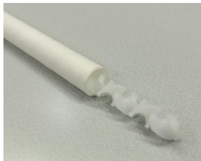
Abbildung 36: Modifikation des Berghof-Membranmoduls durch Integration statischer Mischer in alle 13 Hohlmembranen des Moduls.
