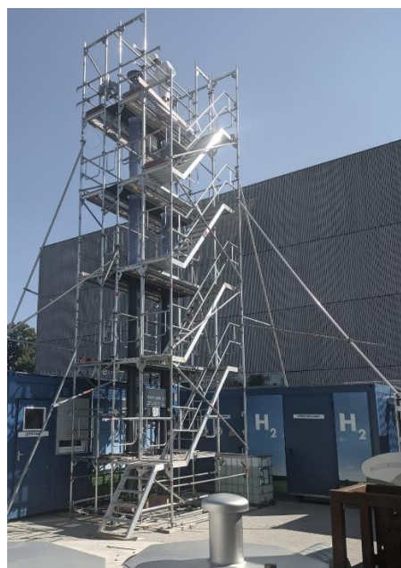
Abbildung 48: Fertiger Versuchsstand, (links) Rohr Entgasungs-Reaktor, (rechts) Rohr Begasungs-Reaktor.
