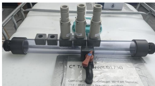
Abbildung 52: Messstrecke mit Schnellwechselarmaturen und Absperrhahn.
