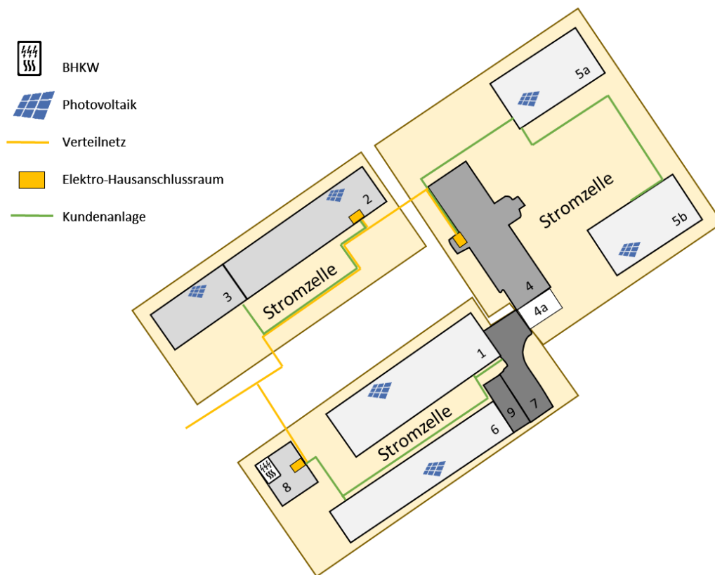
Abbildung 6: Anschlusskonzept Strom mit Kundenanlagen
