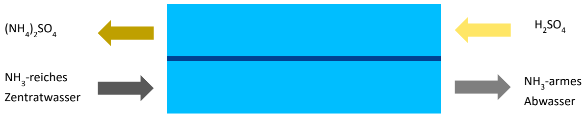
Abbildung 42: Vereinfachte Darstellung der Stoffströme der Membrandestillation
