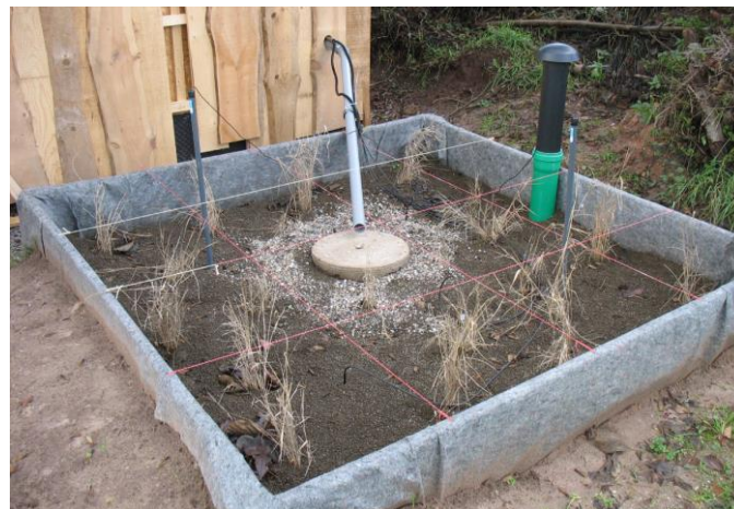
Abbildung 7: Spezialbodenfilter mit Unterteilung der Filteroberfläche in 16 Quadrate
