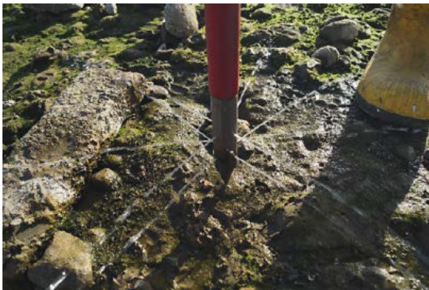
Abbildung 12: Kolmameter mit perforierter Spitze bei Messung an Luft (Quelle: Stein et al. 2018)
