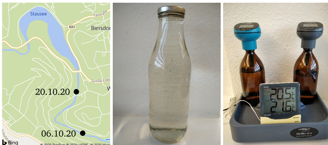
Abbildung 36: Probenahmestellen (bing.com/maps), entnommene Probenflüssigkeit und Versuchsaufbau der Untersuchung auf Sauerstoffzehrung vom 06.10. und 20.10.2020
