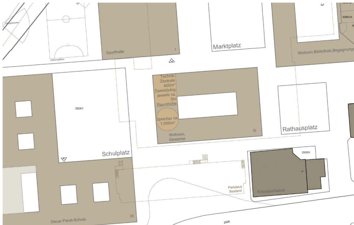
Abbildung 30: Planausschnitt Energiezentrale und Langzeit-Wärmespeicher
