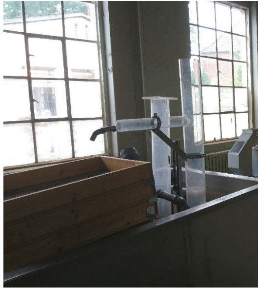
Abbildung 7 Einsatz beider Desagglomeratoren
