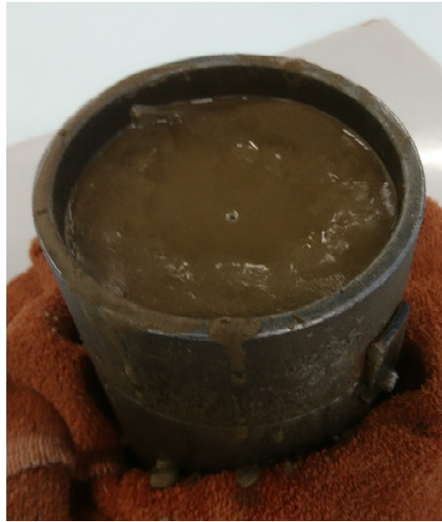
Abbildung 22 Proctorversuch in Anlehnung an ISO 18127: 2012-09
