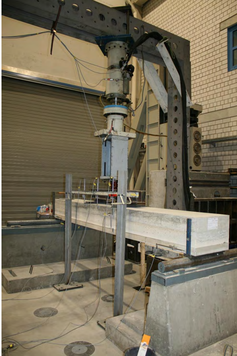
Abbildung 82: Versuchsaufbau für 4-Punkt-Biegeversuche an Sandwichelementen mit Mineralschaumdämmung im Labor für Konstruktiven Ingenieurbau.
