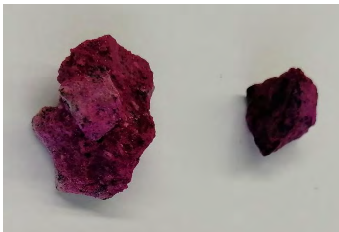
Abbildung 23: Phenolphthaleintest der frisch gebrochenen RC-Gesteinskörnung aus Brückenkappe.
