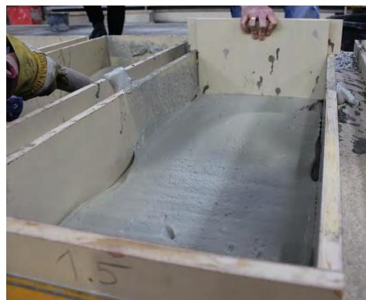
Abbildung 69: Abzug des mineralisierten Dämmschaums.
