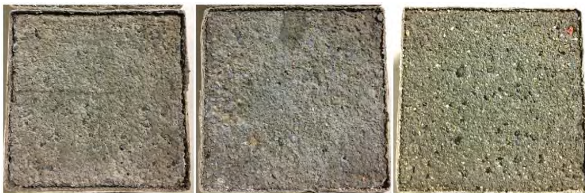
Abbildung 38: Gegenüberstellung - Prüfflächen der Probekörper für CDF-Prüfung.
