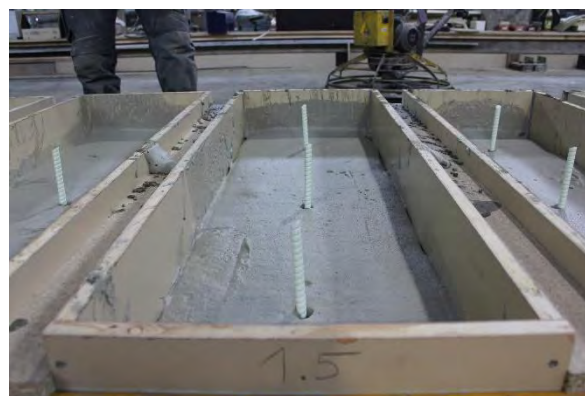
Abbildung 71: Einbringen der Verbindungsmittel.
