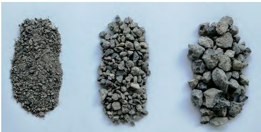
Abbildung 18: Korngruppen 0/2 (links), 2/8 (Mitte) und 8/16 (rechts).
