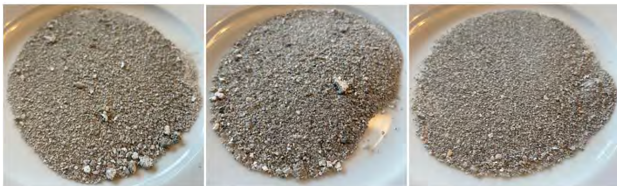
Abbildung 39: Gegenüberstellung - abgewittertes Material nach 28 Frost-Tau-Wechseln.
