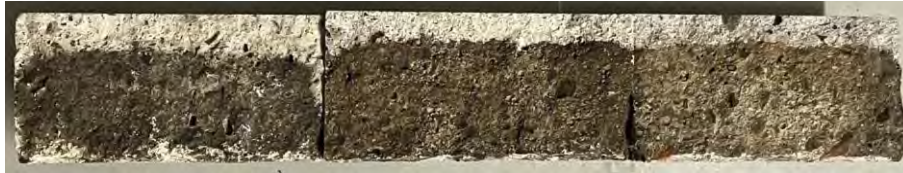
Abbildung 47: Gegenüberstellung – Chlorideindringtiefe an Probekörpern.
