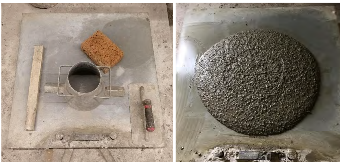
Abbildung 31: Bestimmung des Ausbreitmaßes.
