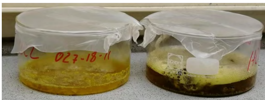
Abbildung 20: Lagerung in Salzsäure.
