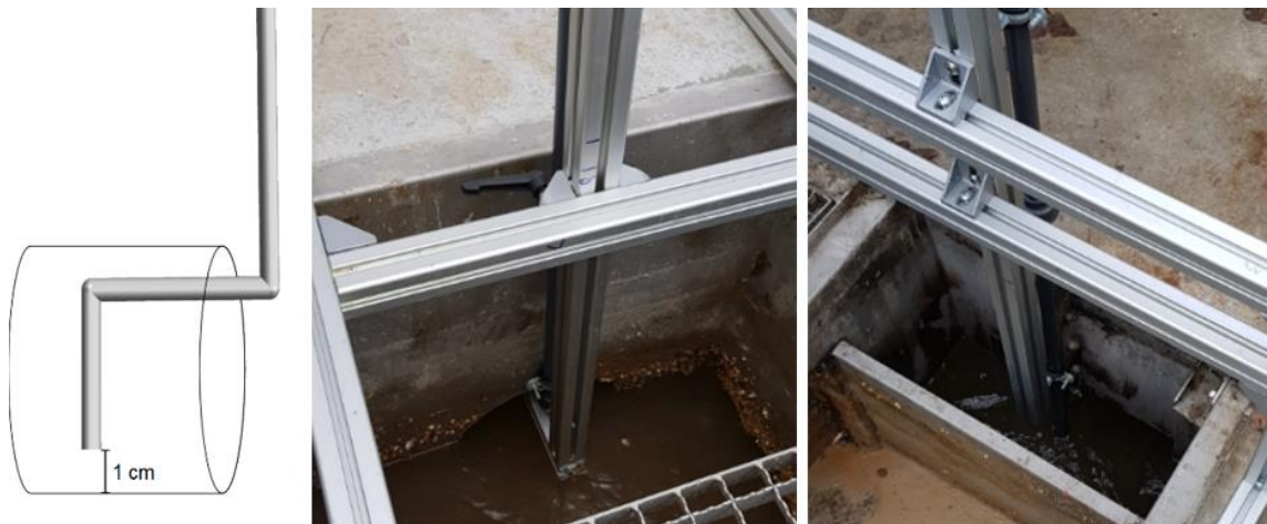
Abbildung 3-8: Saugrohr (links), Beprobung Zulauf (Mitte), Beprobung Ablauf (rechts)
