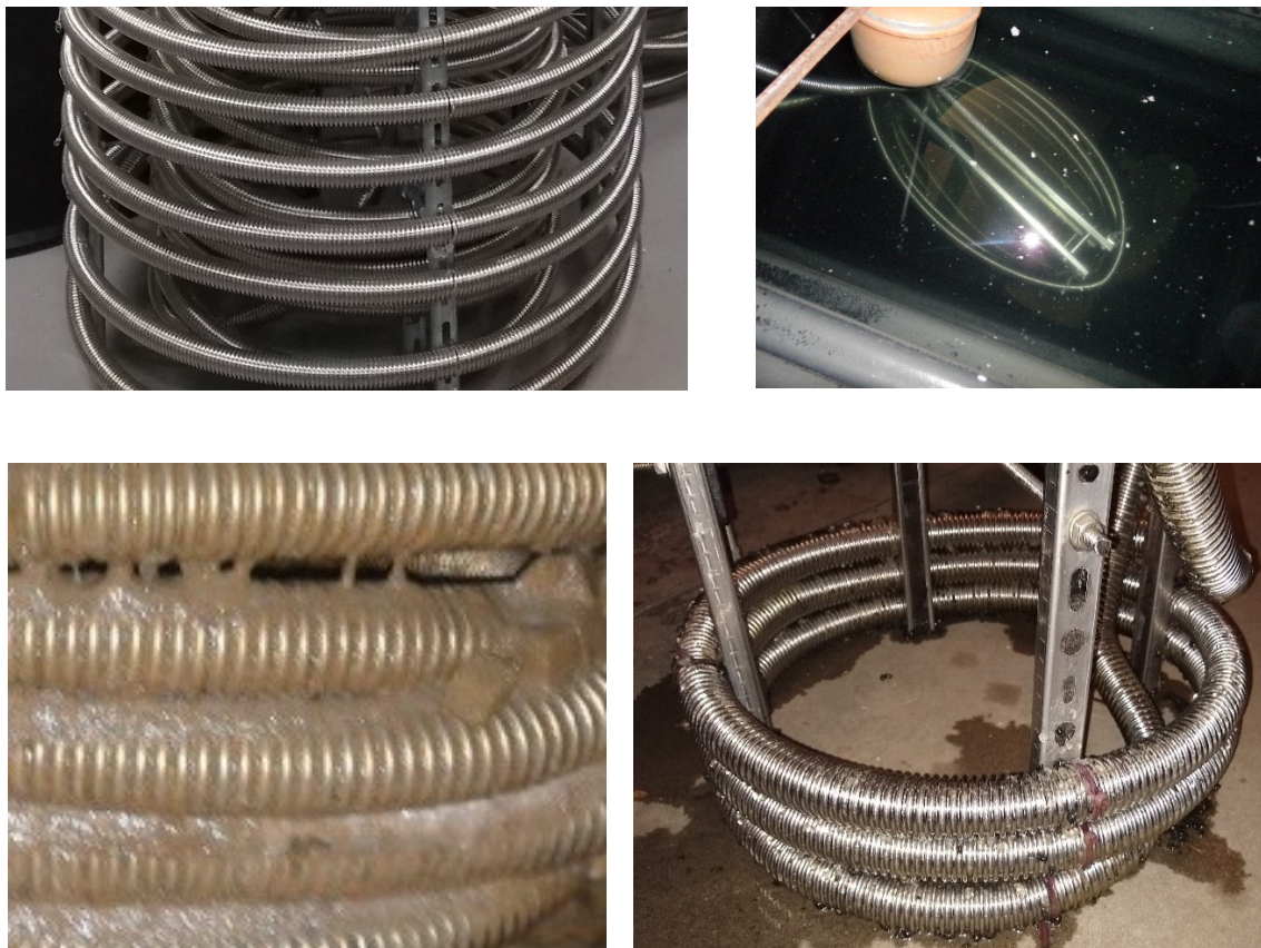
Abbildung 34: Selbst gewickelte Wellrohrwärmetauscher neu und im Betrieb. Oben links: neu, oben rechts: nach 2-jährigem Betrieb im Betriebswasserspeicher. Unten: nach mehreren Monaten im Grauwasserbehälter, links: ohne Reinigung – rechts: mit automatisierter Reinigung.
