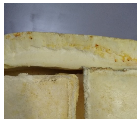
Abbildung 36: Aufbau des Hygienespeichers – und Beispiel eines industriell schlecht gefertigten Speichers mit mangelhafter Isolierung.
