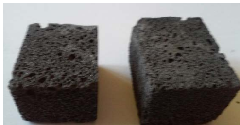
Abbildung 32: Schaumglas rechts hergestellt aus Glassand und links aus anteiligen Einsatz von GAS
