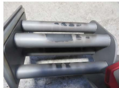
Abbildung 8: fest klebende Anbackungen auf Schutzrohren Magnet
