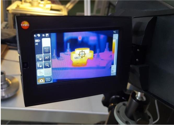
**Bild 8: Falschfarbenbild der Thermokamera während der Messung der Probentemperatur**
