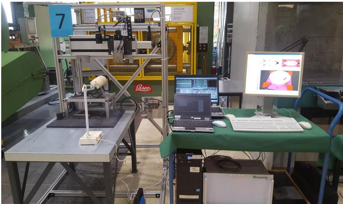
**Bild 5: Labormessplatz, links: Grundgestell mit motorischer Lineareinheit, Sensorik und Probenablageplatz, recht: PC-Technik zur Steuerung des Messplatzes**
