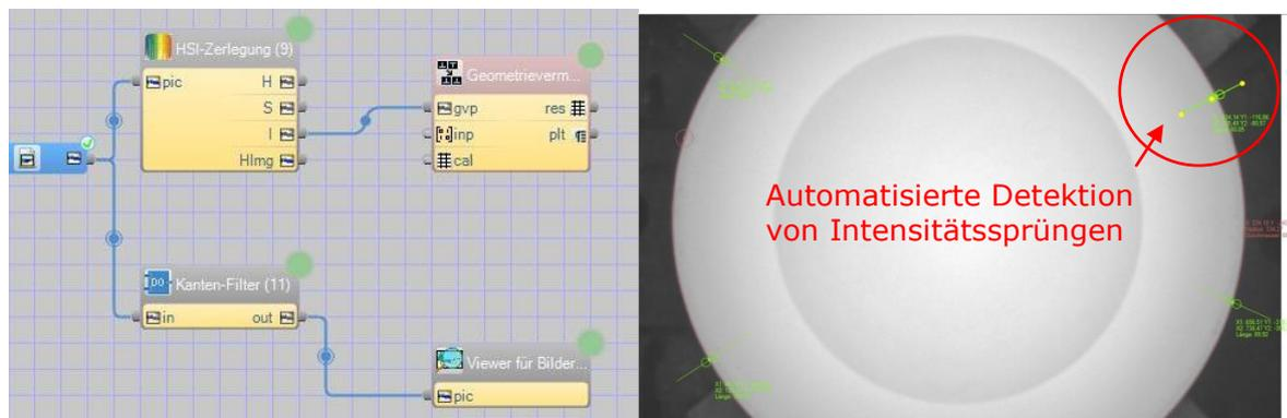
**Bild 16: Ablaufplan der Bewertungssequenz und Detektion von Intensitätssprüngen mit Xeidana®**
