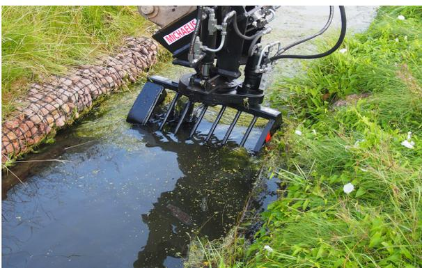
*Insbesondere in urbanen Bereichen und bei zunehmendem Einsatz biologischer Verbaumaßnahmen (hier Steinwalzen) reduziert der Mini-Mähkorb die Gefahr von Uferschäden durch Verhaken beim seitlichen Einschwenken erheblich.*
