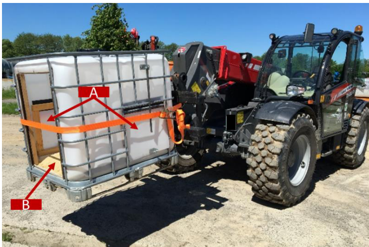
Abbildung 47: Zur Reinigung vorbereiteter „IBcon-Chick“ mit den beiden gegenüberliegenden Auslaufklappen (A) und dem durch die Serviceöffnung sichtbaren Substrat (B)
