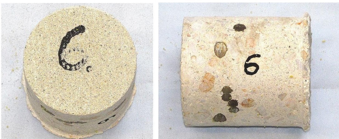
Abbildung A10: Bohrkern 6, entnommen aus einer Fertigteilwand der Südfassade, Stirn- und Seitensicht (außenseitige Wandoberfläche links)
