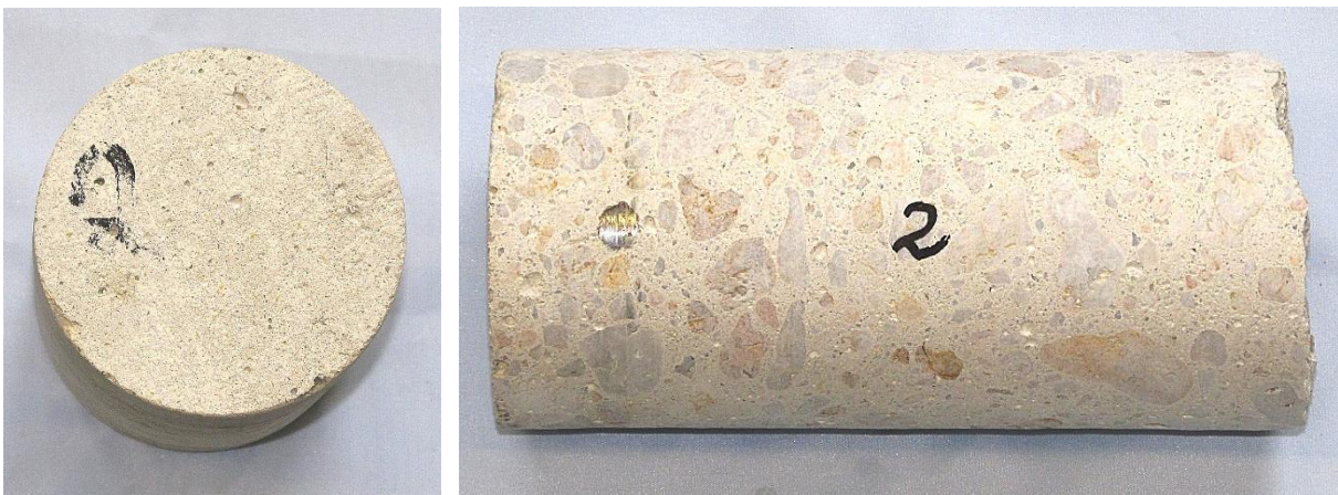
Abbildung A6: Bohrkern 2, entnommen aus einer Ortbetonwand der Nordfassade, Stirn- und Seitensicht (außenseitige Wandoberfläche links)
