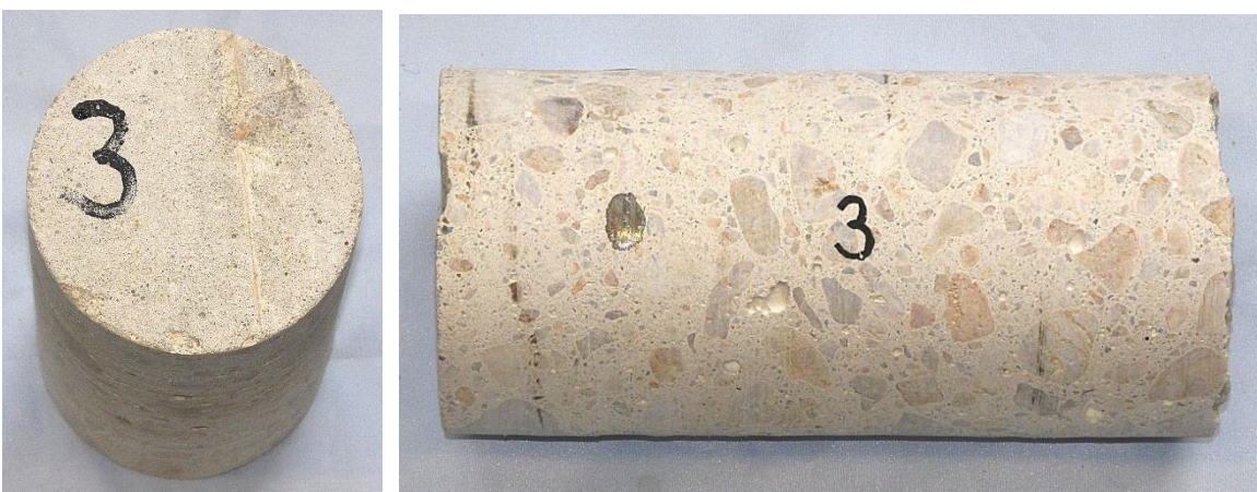
Abbildung A7: Bohrkern 3, entnommen aus einer Ortbetonwand der Ostfassade, Stirn- und Seitensicht (außenseitige Wandoberfläche links)
