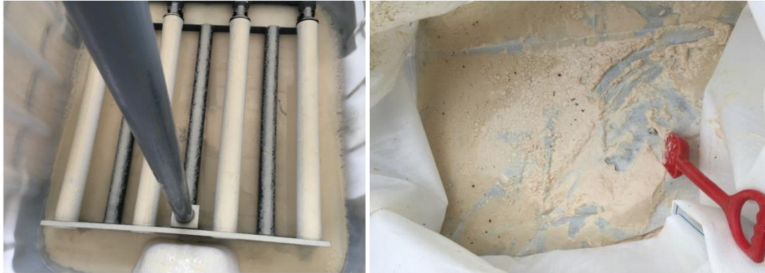
Abbildung 19. Hefeerntung durch Abschaben der Hefen nach Entnahme der Belüftungsanlage aus dem Big Bag.
