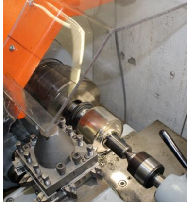
Abbildung 15 Demontageprozess. Von links nach rechts: Auspressen des Stators aus Motorgehäuse. Einspannung des Rotors in Drehmaschine zur Freistellung des Rotorpakets. Ausdrücken der Seltenen Erden Magnete aus Rotorpaket.
