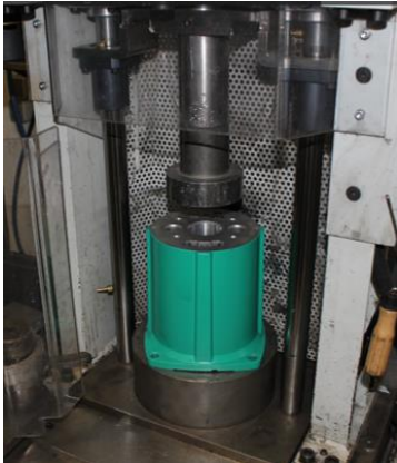
Abbildung 15 Demontageprozess. Von links nach rechts: Auspressen des Stators aus Motorgehäuse. Einspannung des Rotors in Drehmaschine zur Freistellung des Rotorpakets. Ausdrücken der Seltenen Erden Magnete aus Rotorpaket.
