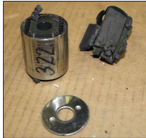
Abbildung 28 Demontage eines zurückgeführten Rotorpakets – Links: Intaktes Rotorpaket mit Seltene Erden Magneten. Rechts: Die enthaltenen SEM sind durch die Demontage beschädigt worden.
