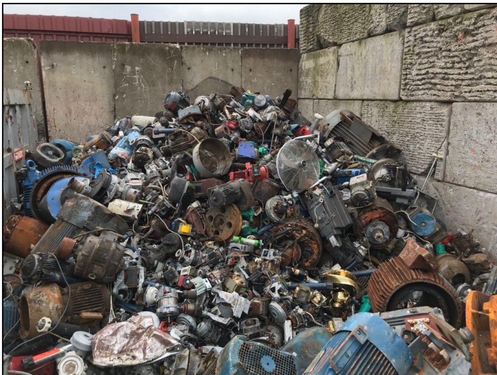
Abbildung 2 Wilo Pumpen im Motoren Schrott - Die Seltenen Erden Magneten gehen verloren
