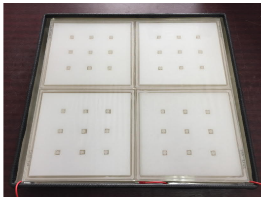
Abbildung 8: DBE-Lampendemonstrator ( 42 \times 38\text{ cm} ) mit einer effektiven Leuchtfläche von ca. 1450\text{ cm}^2 bestehend aus vier Einzellampen
