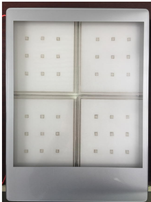
Abbildung 9: DBE-Lampendemonstrator im Vergleich zu einer Abdeckschale eines Bestrahlungsgeräts der Firma Waldmann
