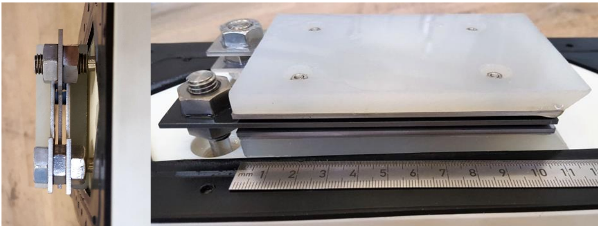
Abbildung 5: Das Innenleben der im Vorhaben verwendeten Durchflussmesszelle der Firma DiaCCon.
