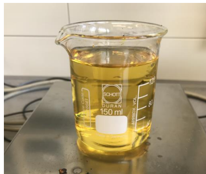
Abbildung 16: Die Probe B2300 unbehandelt färbt sich nach Zugabe von \text{FeCl}_3 , aber bleibt klar.
