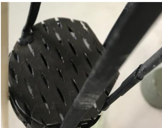
Abbildung 4: Streckmetallelektroden, mit denen sich zur Verhinderung von Ablagerungen eine Queranströmung realisieren lässt.
