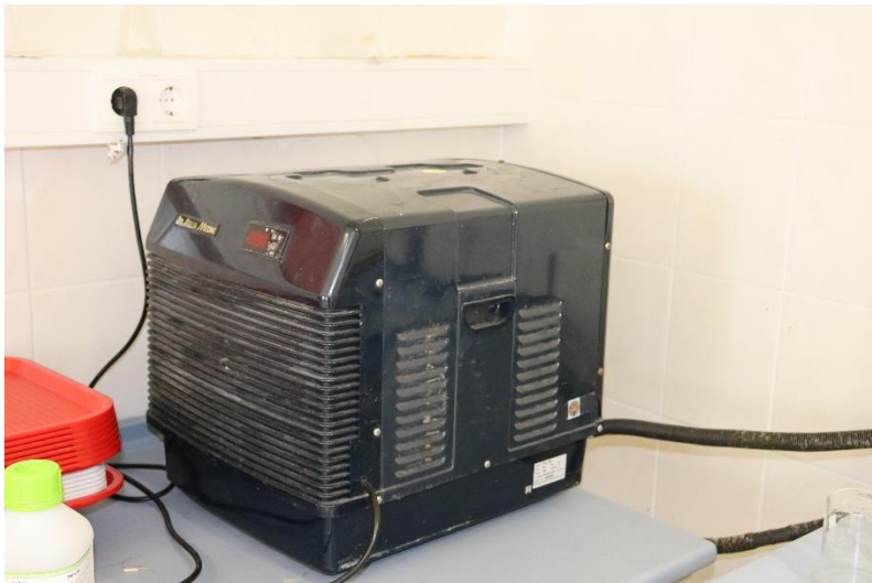
Abbildung 6: Durchlaufkühlgerät zur Aufrechterhaltung der konstanten Wassertemperatur während der Versuchsphase.
