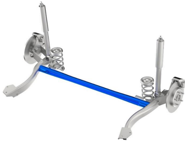
Abbildung 3.2: Verbundlenkerachse als häufigster Vertreter der Halbstarrachsen [20]
