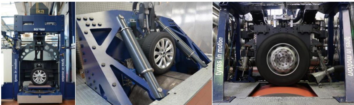
Abbildung 5.11: Zur Parametrierung und Validierung verwendete Reifenprüfstände am ika/fka in Aachen
