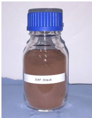
Abb. 2.2: Darstellung des im Projekt eingesetzten Stahlwerksstaubs
