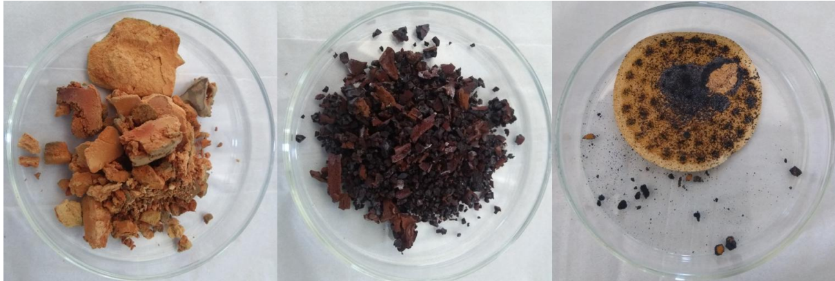
Abb. 4.16: Niederschlag nach Sulfat-Fällung (links); Niederschlag nach oxidativer Fällung (Mitte); Rückstand nach Zementation (rechts)
