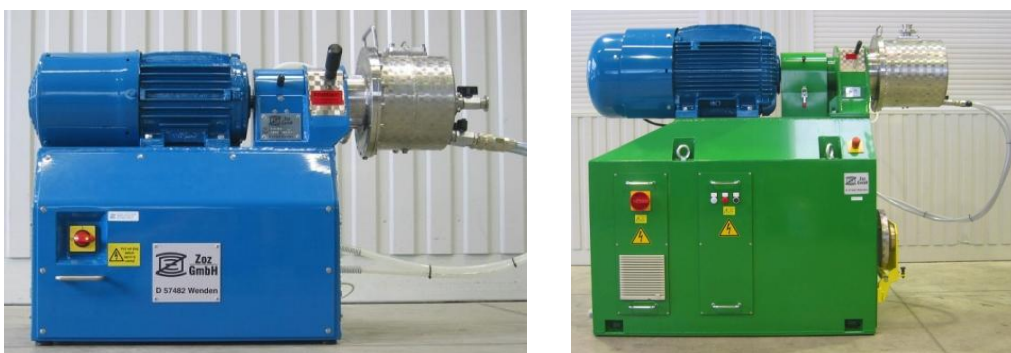
Abb. 3.1: Darstellung der im Projekt eingesetzten Hochenergiemühlen (links: Simoloyer® CM 01 – Labormaßstab; rechts: Simoloyer® CM 20 – technischer Maßstab)
