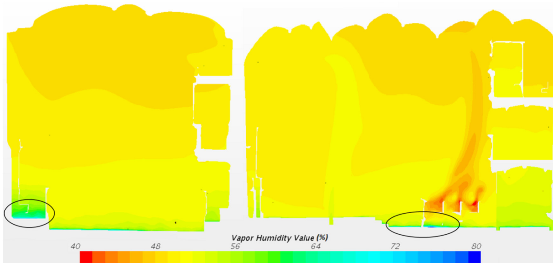
Abb. 2.5-08: Kritische Bereiche mit hoher relativer Luftfeuchtigkeit.
