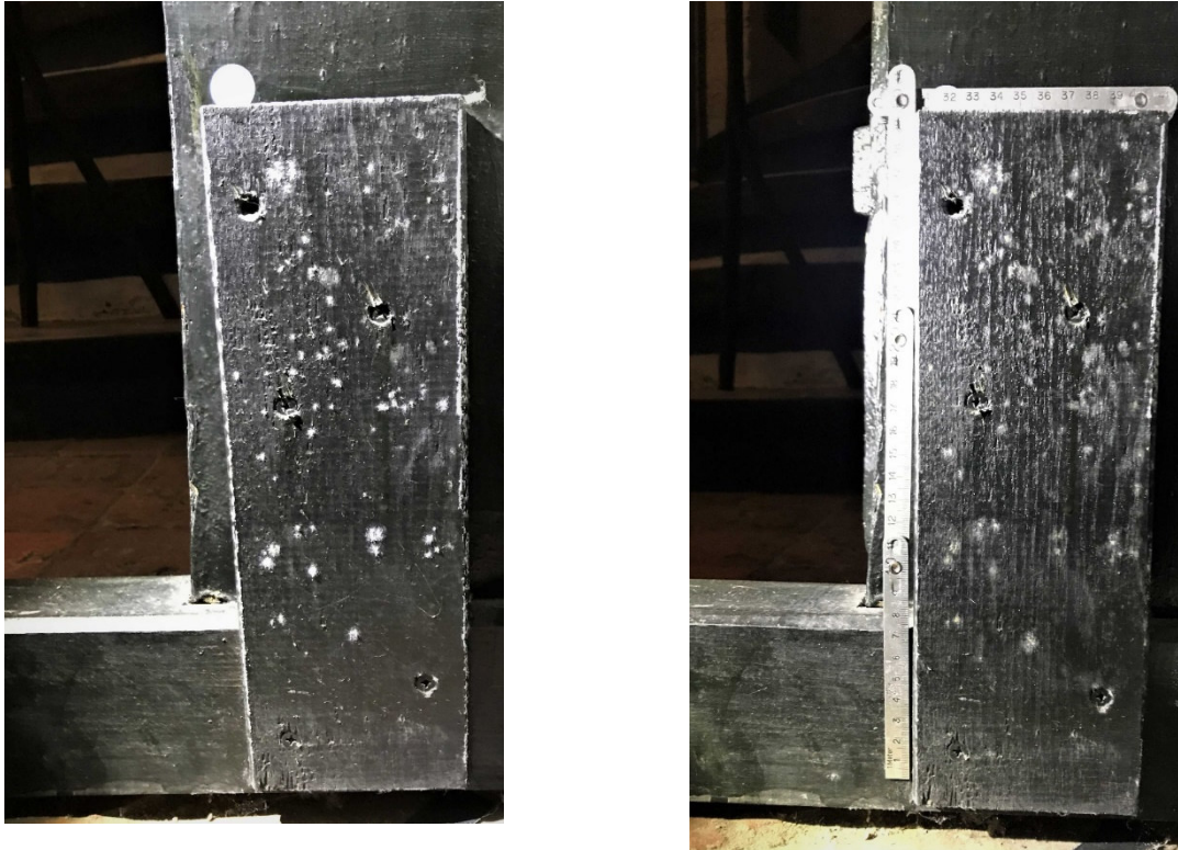
Abb. 2.7-07 und Abb. 2.7-08: Referenzfläche MMB4, Innenseite der südlichen Gestühlwange unten am 04.09.2018 (links) und am 08.07.2019 (rechts): Verblässende Myzelflecken deuten auf eine tendenziell abnehmende mikrobiologische Aktivität (Fotos Fiebiger, NLD)
