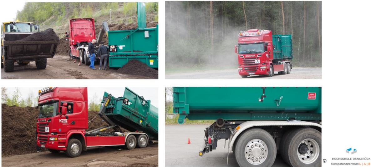
Abbildung 6-12: Befüllung und Aufziehen mit Kompost / Fahrversuche und Absetzen mit Kompost
