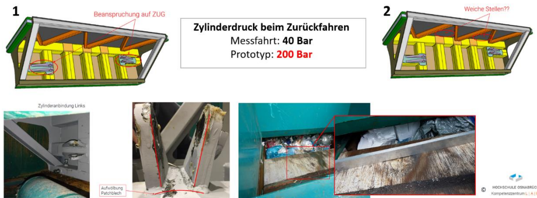
Abbildung 6-46: Komponentenversuche - Erste Beschädigungen
