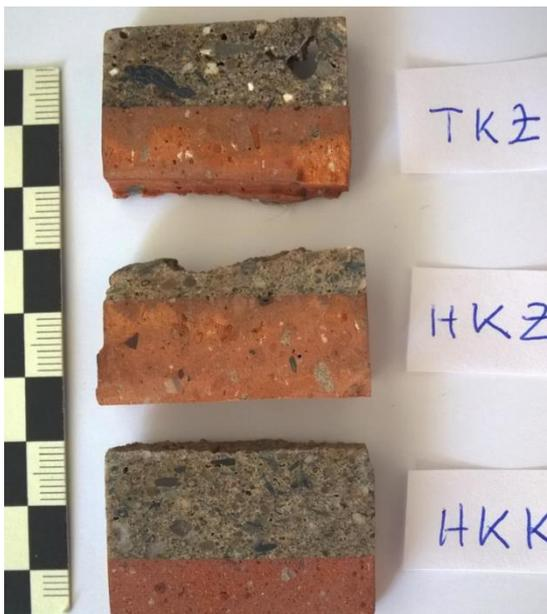
Abb. 72: Senkrecht zur Oberfläche geschnittene Ziegel-Mörtel-Verbundproben (Probe imprägniert, Porenraum teilweise mit Harz gefüllt). Trocken gelöschter Kalkmörtel mit Ziegeluntergrund: TKZ, Heißkalkmörtel mit Ziegeluntergrund: HKZ, Heißkalkmörtel mit Klinkeruntergrund: HKK
