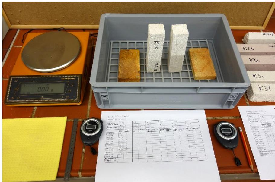
Abb. 11: Versuchsaufbau Messung der kapillaren Wasseraufnahme
