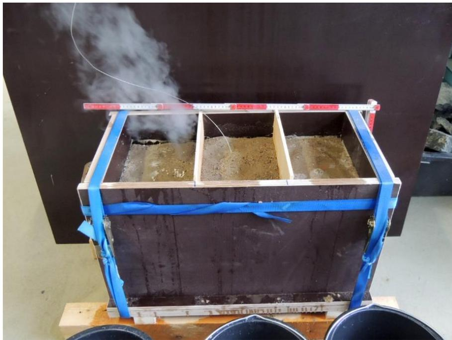
Abb. 18: Löschkasten mit drei Kammern, in dem der Vergleichsmörtel trocken gelöscht wurde
