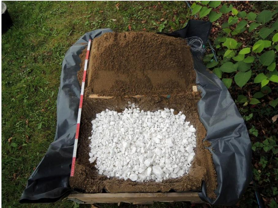
Abb. 19: Vorbereitung der trockengelöschten Grundmischung. Im hinteren Teil des Kastens ist das Haufwerk schon mit Sand bedeckt, im vorderen ist der stückige Branntkalk zu sehen
