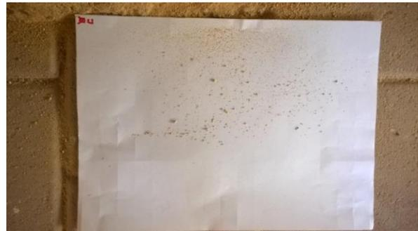
Abb. 112: MF6: Fugenauswurf mit TK, Putzoberfläche mit TK berappt: UNTEN
