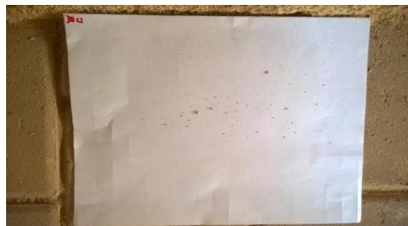
Abb. 116: MF8: Fugenauswurf mit Porengrundputz „PPQ“, Putzoberfläche mit NHL berappt: UNTEN
