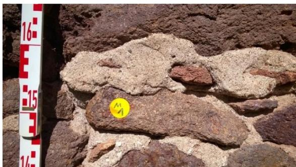
Abb. 49: Kloster Buch, südliche Langhauswand, Südseite: Probenahmepunkt M1 (historischen Putz- und Fugenmörtel)
