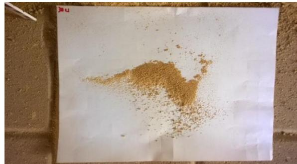
Abb. 108: MF4: Fugenauswurf mit TK berappt, nachbehandelt, gekratzt, gebürstet: UNTEN
