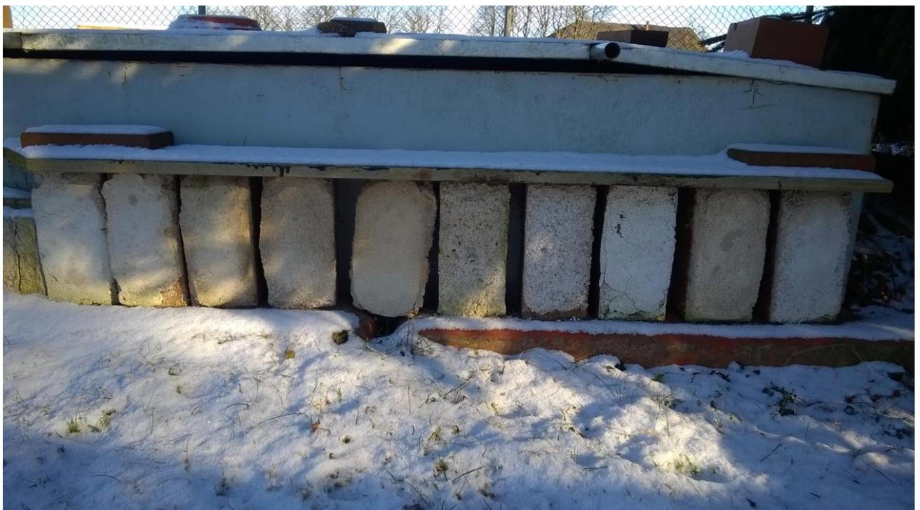
Abb. 68: Ziegel-Musterflächen, Herstellung am 30.09.2017 mit Putzstärken von 2 bis 3 cm, Lagerung im Außenbereich 18 Monate, über zwei Winter (Aufnahme am 09.02.2019)
