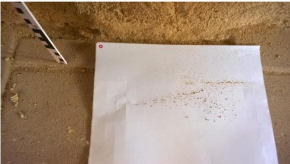
Abb. 111: MF6: Fugenauswurf mit TK, Putzoberfläche mit TK berappt: OBEN
