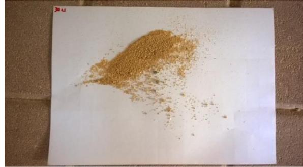
Abb. 102: MF1: Fugenauswurf mit HK berappt, nachbehandelt, gekratzt, gebürstet: UNTEN
