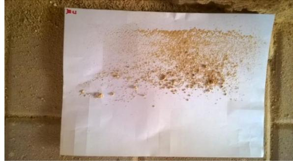
Abb. 110: MF5: Fugenauswurf mit TK berappt: UNTEN
