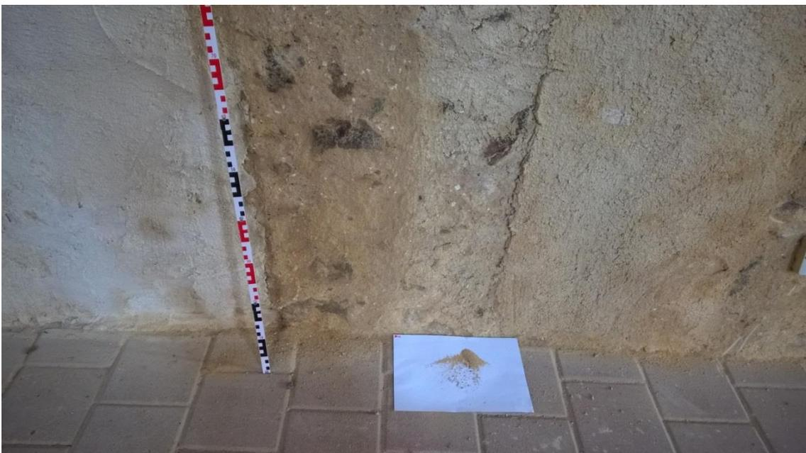
Abb. 100: Vergleichende Untersuchungen zum Absanden der Putzoberflächen in den Höhenstufen 60 cm bis 70 cm und 160 cm bis 170 cm durch Abpinseln einer Fläche von 10 x 10 cm
