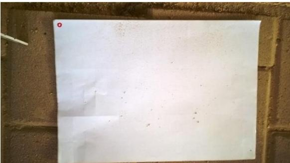
Abb. 113: MF7: Fugenauswurf mit Porengrundputz „PPQ“ (Baumit) berappt: OBEN
