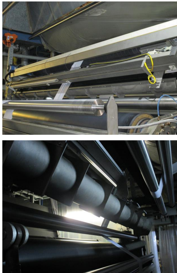
Abb. 2.2: Saugbalken an einer Textilveredelungsanlage der Fa. Thorey. Vorderseite (oben) bzw. Rückseite (unten).
