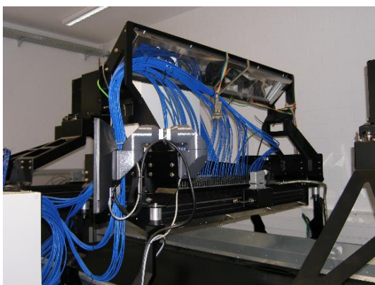
Abb. 4.16: Messbrücke des NIR-Multiplexer-Spektrometers an einer Testanlage bei LLA Instruments. Gut zu erkennen ist die linear angeordnete Messkopfzeile mit den zugehörigen Lichtleitkabeln. Spektrometer und Multiplexer befinden sich im Gehäuse auf der linken Seite.
