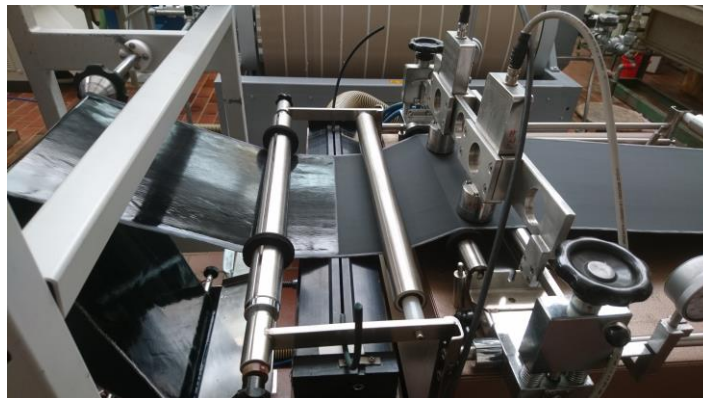
Abb. 3.11: Versuchsaufbau mit Saugbalken und Sensoren
