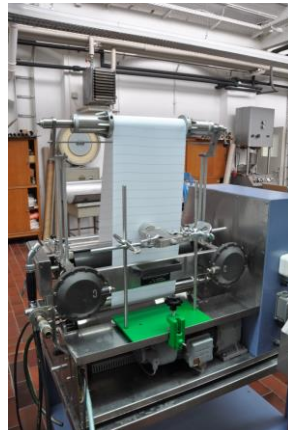
Abb. 3.8: Foulard mit Endlostextilband und Mikrowellensensor (Bildmitte)
