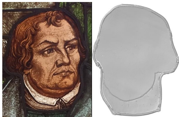
Abb. 10: Links: Durchlichtaufnahme von nX3b (Oleszczuk 2019). Rechts: 3D-Scan der Rückseite der Scheibe.
